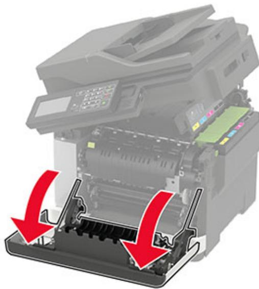
**3** Öffnen Sie die Zugriffsklappe der Fixierstation, und entfernen Sie das gestaute Papier.
