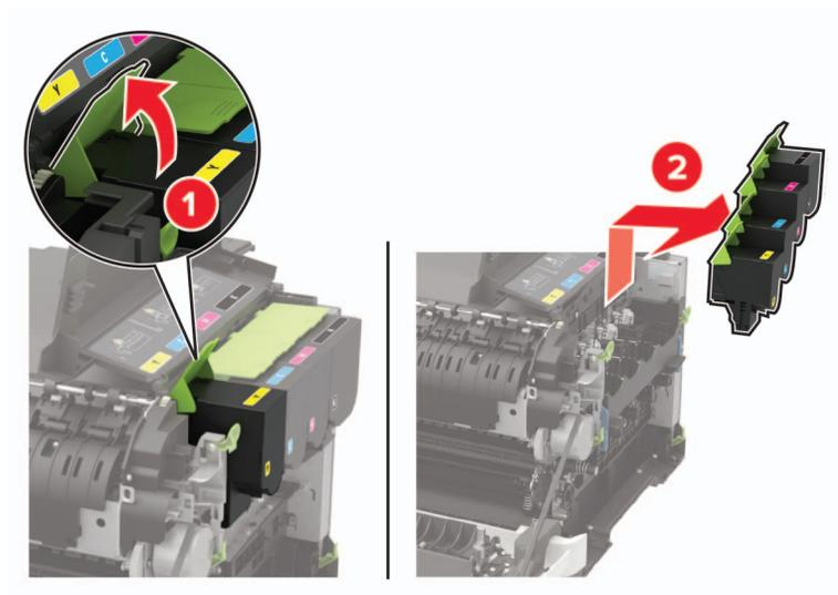
**6** Entfernen Sie die gebrauchte Imaging-Einheit.
