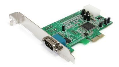
Mit der PCI Express-Seriell-Adapterkarte PEX1S553 können Sie einen PCI Express-Steckplatz in einen seriellen RS232 (DB9)-Anschluss verwandeln.
