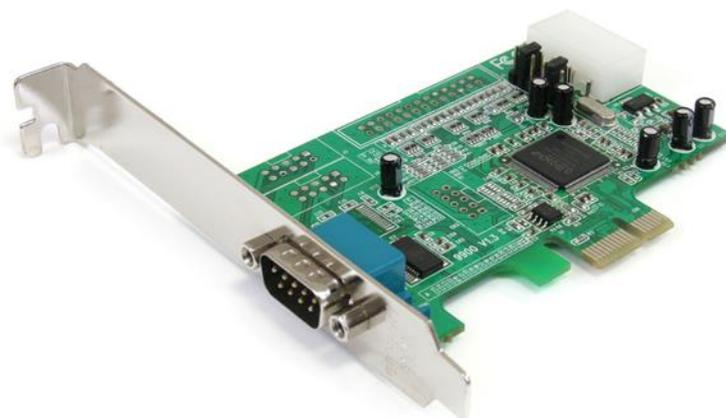
La carte adaptateur série PCI Express PEX1S553 vous permet de transformer un logement PCI Express en une connexion série RS232 (DB9). Reposant sur une conception de puce unique native permettant d'optimiser les capacités de PCI Express (PCIe), la carte réduit la charge appliquée à l'ordinateur d'au plus 48 %, par rapport aux cartes série conventionnelles à puce de pont.
