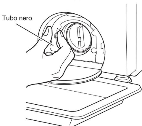
3. Posizionare un panno di cotone sotto il filtro della pompa di scarico per assorbire tutta l'acqua eventualmente rimasta al suo interno. Successivamente, rimuovere il filtro della pompa di scarico ruotandola in senso antiorario.
