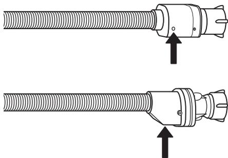
Controllare la finestra di ispezione della valvola di sicurezza (vedere la freccia). Se è rossa, significa che la funzione di protezione dall'allagamento è entrata in funzione; in questo caso, è necessario sostituire il tubo con uno nuovo. Per scollegare il tubo, premere il pulsante di rilascio (se presente) e svitare il tubo.
