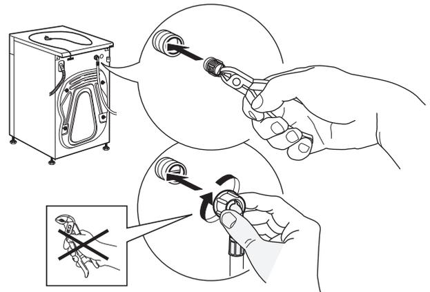
**3.** A questo punto, svitare manualmente il tubo di carico dalla parte posteriore della lavatrice. Utilizzando delle pinze, estrarre il filtro a rete dalla valvola nella parte posteriore della lavatrice e pulirlo.
