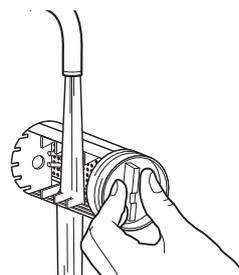
5. Reinscrivere il filtro della pompa di scarico ruotandolo in senso orario. Assicurarsi di ruotarlo al massimo, lasciando la maniglia del filtro in posizione verticale.
