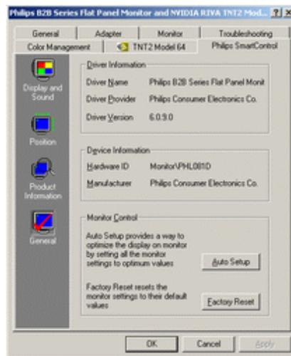
All'interno di Monitor control (Controllo monitor), gli utenti possono fare clic su Auto Setup (Setup automatico) per ottenere prestazioni ottimali; oppure fare clic su Factory reset (Ripristina valori predefiniti) per reimpostare i parametri del monitor. Queste opzioni sono disabilitate se si utilizza l'ingresso DVI-D (digitale).
