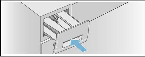
**Hinweis:** Lassen Sie die Waschmittelschublade offen, damit Restwasser abtrocknen kann.
