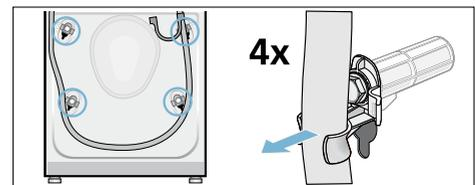
2. Netzleitung aus den Halterungen nehmen. Alle 4 Transportsicherungsschrauben mit einem Schraubenschlüssel SW13 lösen und entfernen. Hülsen entfernen.
