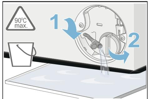
6. Pumpendeckel vorsichtig abschrauben, Restwasser kann auslaufen. Innenraum, Gewinde des Pumpendeckels und Pumpengehäuse reinigen. Das Flügelrad der Laugenpumpe muss sich drehen lassen.
