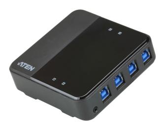
Der ATEN US3344 ist ein 4-Port USB 3.2 Gen1 Peripherie-Freigabegerät, das es Benutzern ermöglicht, vier USB-Geräte mit Hilfe von USB 3.2 Gen 1-Typ-B auf Typ-A Kabeln zwischen 4 verschiedenen Computern zu teilen.
