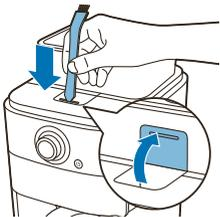
5 Verwenden Sie das Ende der Reinigungsbürste für die Kaffeebohenschütte, um den Deckel des Mahlwerktrichters zu öffnen.
