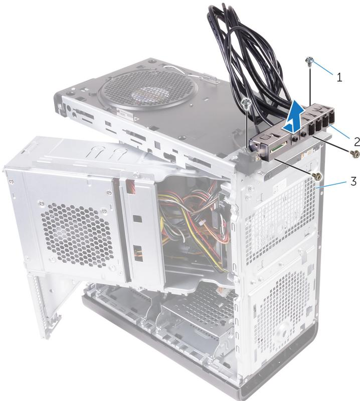
**Abbildung 28. Entfernen der USB-Leiste**
