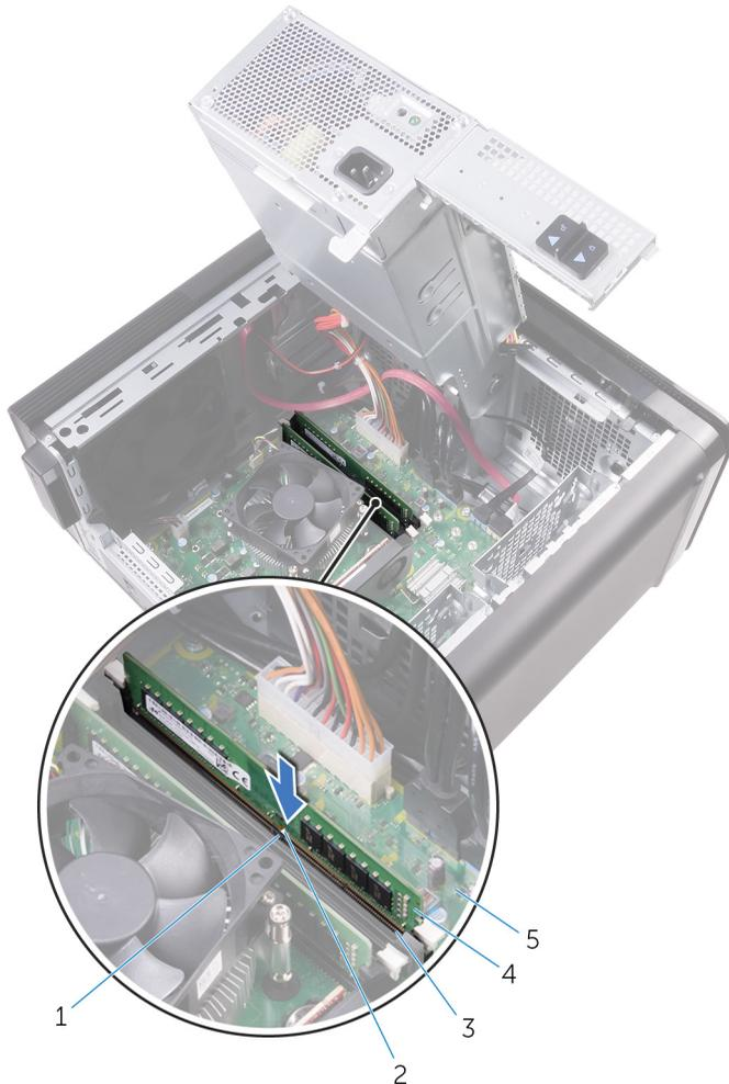
**Abbildung 25. Austauschen des Speichermoduls**
