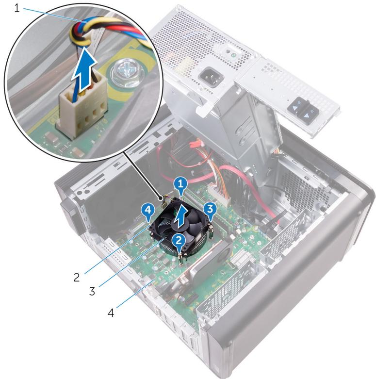
**Abbildung 33. Entfernen von Prozessorlüfter und Kühlkörper**
