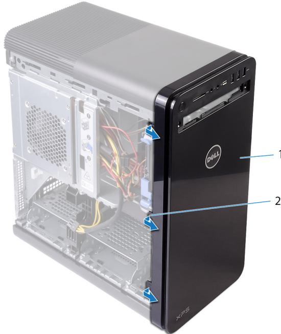
**Abbildung 3. Entfernen der Frontverkleidung**
