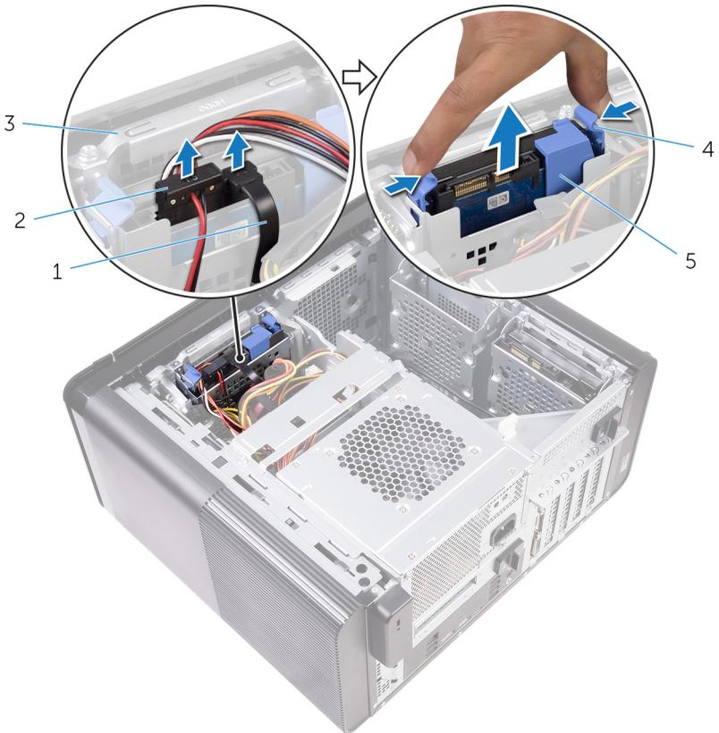
**Abbildung 13. Entfernen der Festplattenbaugruppe**
