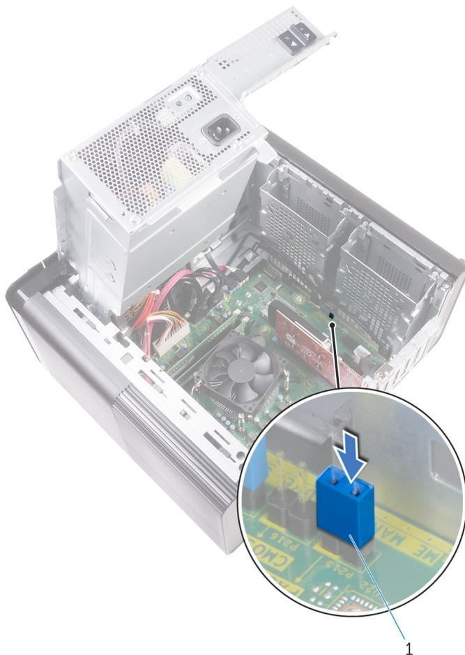
**Figure 45. Effacement du mot de passe**
