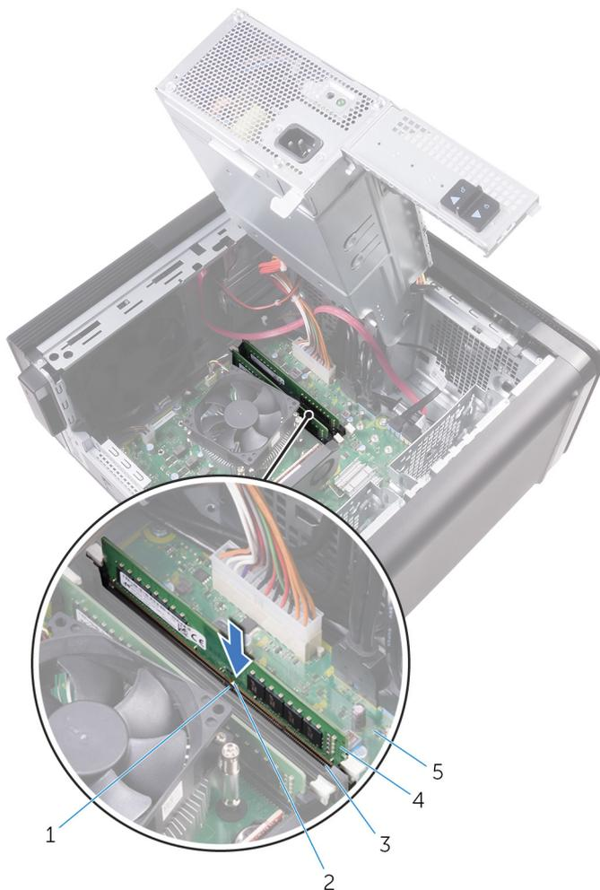
**Figure 25. Remise en place du module de mémoire**
