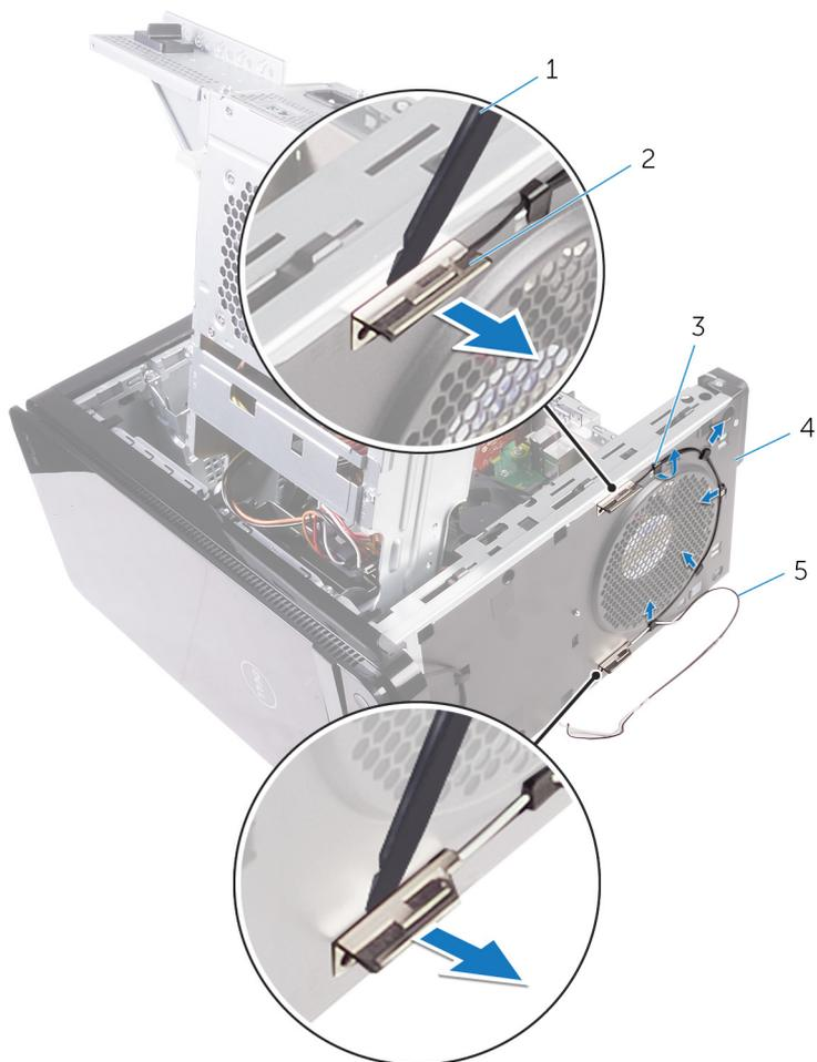
**Figure 41. Retrait de l'antenne**
