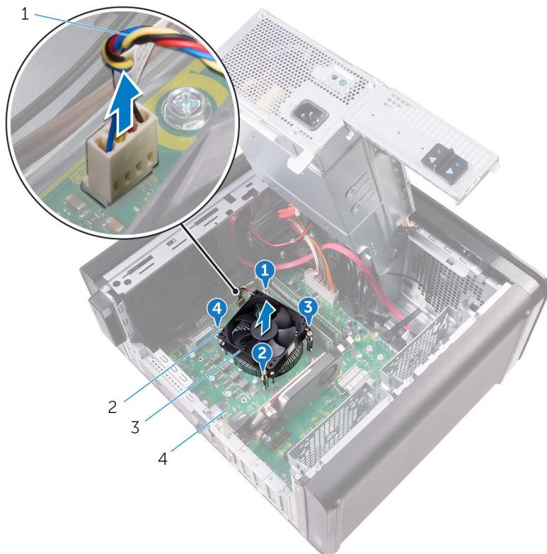
**Figure 33. Retrait du ventilateur du processeur et du dissipateur de chaleur**
