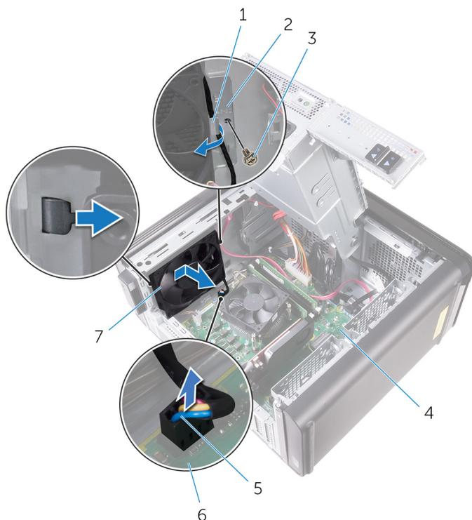
**Figure 34. Retrait du ventilateur du châssis**
