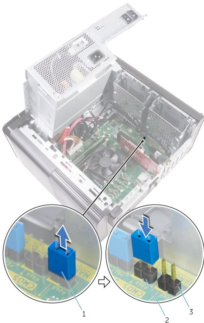
**Figure 43. Effacement des paramètres CMOS**
