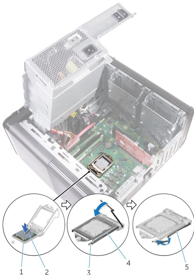
**Figure 37. Remise en place du processeur**
