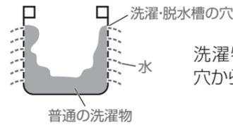
洗濯物の水は洗濯・脱水槽の穴から抜けます。
