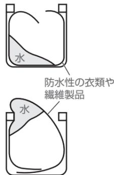
洗濯・脱水槽が回転しても水が防水性の衣類や繊維製品から抜けられないため、水が片寄って大振動を引き起こします。
