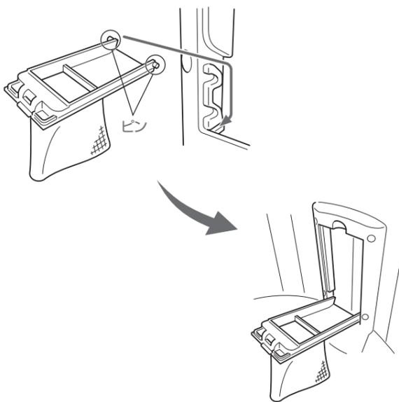
矢印のように糸くずフィルターの左右のピンを差し込み、取り付けを行ってください。(取り外しは逆の手順で行ってください。)
