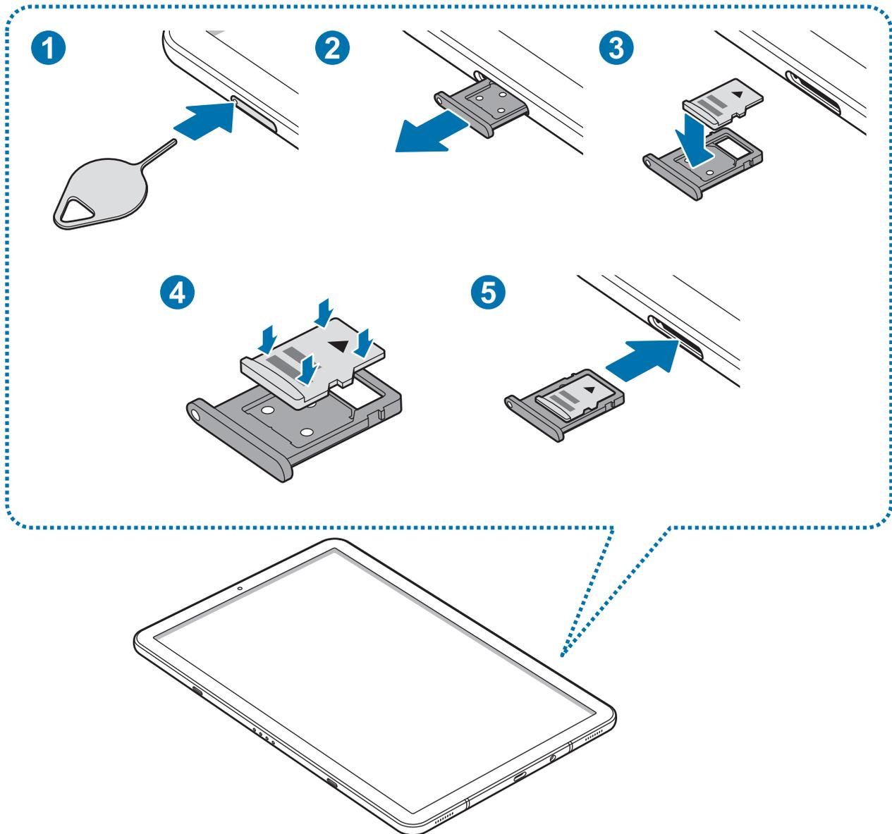
1 Insérez l'outil de retrait à l'endroit prévu à cet effet sur le compartiment pour le déverrouiller.
