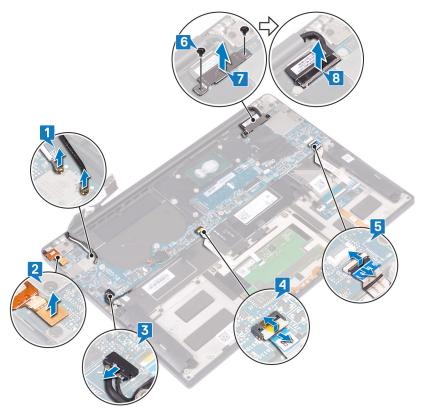
**9** Retirez les 10 vis (M1,6x2,5) qui fixent la carte système à l'assemblage de repose-mains.
