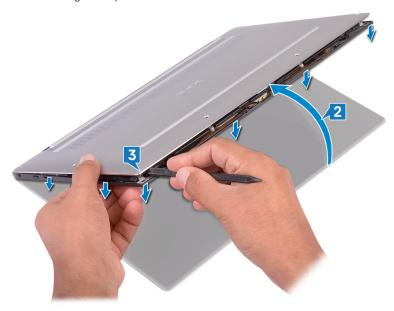
4 Lorsque vous faites glisser le cache de fond de gauche à droite, libérez les clips qui fixent le cache de fond à l'assemblage de repose-mains.
