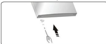
10. Ändern Sie die Schraubenlochabdeckungen auf der mittleren Deckplatte von links nach rechts (wie in der Abbildung unten gezeigt).
