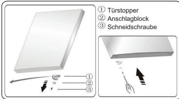
8. Lösen Sie die Schrauben, die für das Befestigen des mittleren Scharniers verwendet werden, und entfernen Sie das mittlere Scharnier, und dann entfernen Sie die untere Tür.
