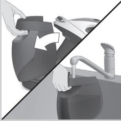
Vul het waterreservoir voor ieder gebruik of wanneer het 'Waterreservoir leeg'-lampje knippert. U kunt het waterreservoir op ieder gewenst moment tijdens het gebruik bijvullen.
