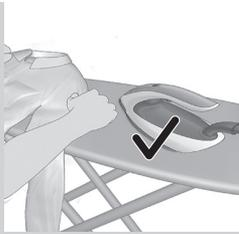
Durante o engomar, pode colocar o ferro na plataforma do ferro ou horizontalmente na tábua de engomar. Graças à tecnologia OptimalTEMP, a base do ferro não danifica a protecção da tábua de engomar.
