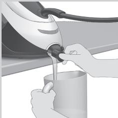
**4** Retirez le bouton EASY DE-CALC et laissez l'eau s'écouler avec les dépôts de calcaire dans la tasse.
