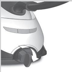
**5** Lorsque toute l'eau est sortie de l'appareil, remettez le bouton EASY DE-CALC en place et tournez-le dans le sens des aiguilles d'une montre pour le repositionner.
