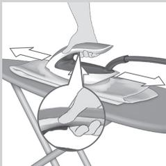
**Bemærk:** I intelligent automatisk damptilstand kommer der damp ud automatisk, når du bevæger strygejernet, og den stopper, når du holder op med at bevæge strygejernet. Du kan stadig trykke på dampudløseren i denne tilstand for at aktivere damp, når strygejernet ikke er i bevægelse.
