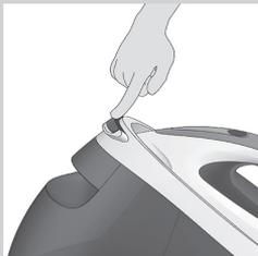
**4** Drücken Sie die Entriegelungstaste für die Transportverriegelung, um das Bügeleisen von der Abstellfläche zu trennen.
