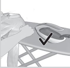
Mientras plancha, puede colocar la plancha en su plataforma u horizontalmente en la tabla de planchar. Gracias a la tecnología OptimalTEMP, la suela no dañará la funda de la tabla de planchar.
