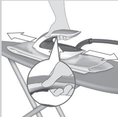
**Hinweis:** Im intelligenten automatischen Dampfmodus tritt automatisch Dampf aus, wenn Sie das Bügeleisen bewegen; es wird kein Dampf abgegeben, wenn Sie das Bügeleisen anhalten. Sie können den Dampfauslöser in diesem Modus weiterhin verwenden, um einen Dampfstoß ohne Bewegung des Bügeleisens auszugeben.
