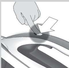
**Nota: no modo de vapor automático e inteligente, o vapor sai automaticamente quando move o ferro e pára quando pára de o mover. Pode premir o botão de vapor neste modo para activar o vapor quando o ferro não está em movimento.**
