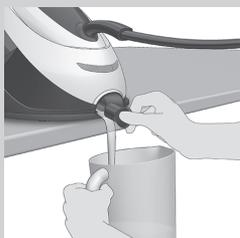
**3** Tenere una tazza (con una capacità di almeno 350 ml) sotto la manopola EASY DE-CALC e ruotare la manopola in senso antiorario.
