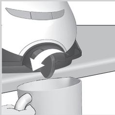
**3** Halten Sie eine Tasse mit einem Fassungsvermögen von mindestens 350 ml unter den EASY DE-CALC-Verschluss, und drehen Sie den Verschluss gegen den Uhrzeigersinn.
