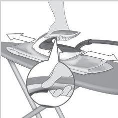
**Nota:** En el modo de vapor automático inteligente, el vapor sale automáticamente al mover la plancha y se detiene al dejar de moverla. Asimismo, puede pulsar el botón de vapor en este modo para activar el vapor si la plancha no está en movimiento.
