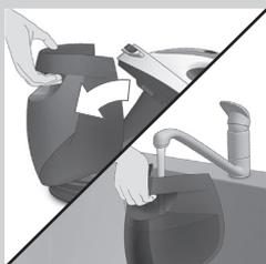
Riempire il serbatoio dell'acqua prima di ogni uso o quando lampeggia la spia "serbatoio dell'acqua vuoto". È possibile riempire il serbatoio dell'acqua in qualsiasi momento durante la stiratura.
