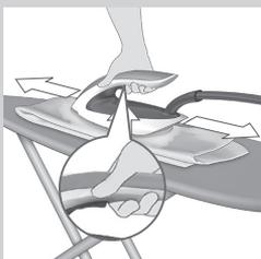
**Σημείωση:** Στη λειτουργία έξυπνης αυτόματης παραγωγής ατμού, ο ατμός βγαίνει αυτόματα όταν μετακινείτε το σίδερο και σταματά όταν σταματάτε την κίνησή του. Μπορείτε να πατήσετε τη σκανδάλη ατμού σε αυτήν τη λειτουργία, για να ενεργοποιήσετε τον ατμό όταν το σίδερο δεν κινείται.
