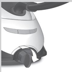
**5** När inget mer vatten kommer ut ur apparaten sätter du tillbaka EASY DE-CALC-knappen och vrider den medurs för att sätta fast den.
