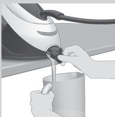
**3** Placez une tasse (d'une contenance de 350 ml au moins) sous le bouton EASY DE-CALC et tournez-le dans le sens inverse des aiguilles d'une montre.
