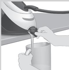
**3** Plasser en kopp (med en kapasitet på minst 350 ml) under EASY DE-CALC-knotten, og vri knotten mot klokken.
