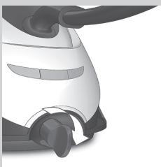
**5** Wenn kein Wasser mehr aus dem Gerät fließt, setzen Sie den EASY DE-CALC-Verschluss wieder auf, und drehen Sie ihn im Uhrzeigersinn fest.
