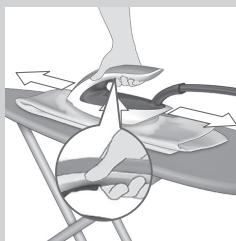
der **DynamIQ**-Sensor die Bewegungen Ihres Bügeleisens und gibt automatisch die richtige Menge an Dampf aus, ohne dass Sie den Dampfauslöser drücken müssen. Dadurch erhalten Sie schneller und einfacher optimale Ergebnisse.
