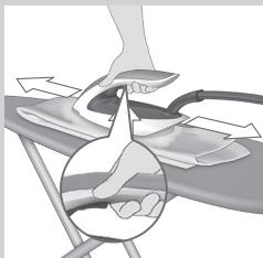
De intelligente *Dynam*iQ**-sensor in uw strijkijzer weet precies wanneer en hoe uw strijkijzer beweegt. Wanneer u de intelligente automatische stoommodus activeert, herkent de *Dynam*iQ**-sensor de bewegingen van uw strijkijzer zodat uw strijkijzer automatisch de juiste hoeveelheid stoom kan afgeven zonder dat u de stoomhendel hoeft in te drukken. Dit helpt u om sneller en gemakkelijker geweldige resultaten te bereiken.
