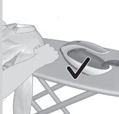
När du stryker kan du antingen ställa strykjärnet på strykstället eller vågrätt på strykbrädan. Tack vare OptimalTEMP-tekniken skadar stryksulan inte strykbrädsöverdraget.
