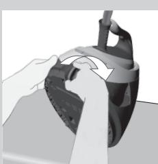
7 Ha kvar EASY DE-CALC-öppningen vänd uppåt, sätt tillbaka EASY DE-CALC-knappen och fäst den genom att vrida den medurs.
