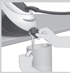
**3** Tenere una tazza (con una capacità di almeno 350 ml) sotto la manopola EASY DE-CALC e ruotare la manopola in senso antiorario.
