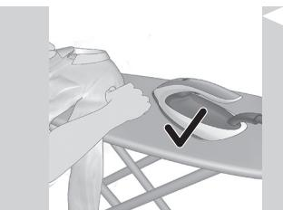
Tijdens het strijken kunt u het strijkijzer op het strijkijzerplateau of horizontaal op de strijkplank plaatsen. Dankzij de OptimalTEMP-technologie beschadigt de zoolplaat niet de strijkplankhoes.
