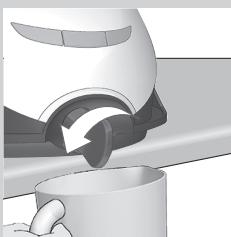
4 Håll en kopp (med en volym på minst 350 ml) under EASY-DE-CALC-knappen och vrid knappen moturs.
