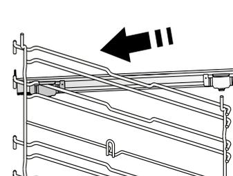
Ancorare alla griglia laterale la clip superiore della guida e farla scivolare fino a fine corsa; abbassare in posizione l'altra clip.
