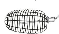
È molto importante posizionare accuratamente la sonda per ottenere risultati di cottura perfetti. Inserire la sonda a fondo nella parte più carnosa, evitando ossa e parti grasse.
