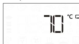
Pritisnite , da začnete z nastavljanjem. Obrnite gumb, da nastavite želeno temperaturo sonde za meso. Pritisnite , da nastavitev potrdite. Obrnite gumb, da nastavite temperaturo pečice.
