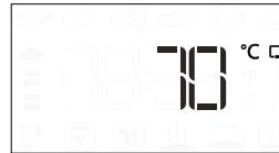
Stiskem spusťte nastavení. Otáčením ovladače nastavte cílovou teplotu sondy. Stiskem volbu potvrďte.
