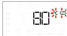
Roțiți selectorul pentru a seta temperatura cavitatei cuptorului.
