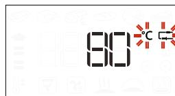
Nospiediet vai lai apstiprinātu un sāktu gatavošanas ciklu. Gatavošanas cikla laikā, displejā būs redzama gaļas zondes mērķa temperatūra. Kad gaļa sasnieggs iestatīto temperatūru, gatavošanas cikls beigsies un siplejā būs redzams uzraksts „End”.
