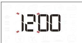
Števki za uro začneta utripati. Z obračanjem gumba nastavite uro in pritisnite za potrditev.
