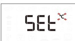
Okrenite gumb za odabir mjerne jedinice i zatim pritisnite za potvrdu.
