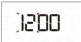
Na displeji začnou blikat dvě číslice nastavení hodin: Pro nastavení hodin otáčejte ovladačem a stisknutím volbu potvrďte.
