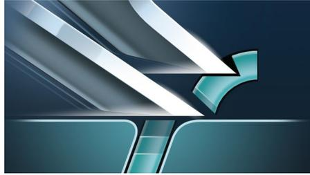
Rasatura più profonda con il sistema Super Lift & Cut a due lame. La prima lama solleva il pelo e la seconda lo taglia sotto la superficie cutanea, per risultati perfetti.
