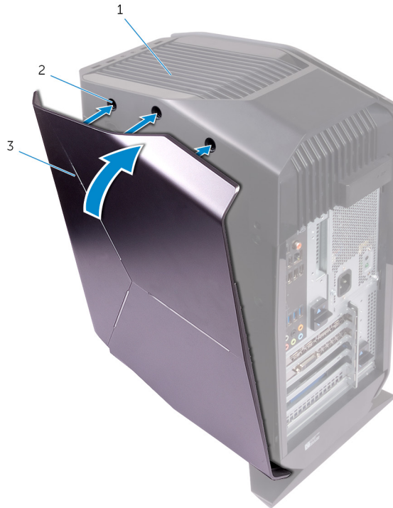
Abbildung 7. Anbringen der rechten Abdeckung
