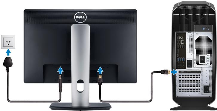
**ANMERKUNG:** Der DisplayPort auf der Rückseite des Computers verfügt über eine Abdeckung. Zum Anschluss des Bildschirms an die separate Grafikkarte des Computers.
