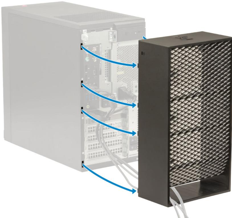
11 Abra la pestaña, quite los cables del sostén [1] y desconecte los cables de los puertos del sistema [2]. Quite los cables de la ranura de la cubierta de cables [3].
