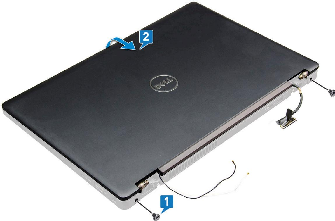
7 Deslice hacia arriba el ensamblaje de la pantalla y retírelo de la del equipo.
