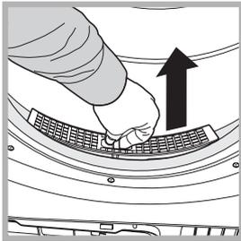
cui il filtro si dovesse intasare il flusso d'aria all'interno dell'asciugatrice verrebbe gravemente compromesso: i tempi di asciugatura si allungano e si consuma più energia. Inoltre, possono verificarsi danni all'asciugatrice. Il filtro si trova davanti alla guarnizione dell'asciugatrice (vedi figura).
