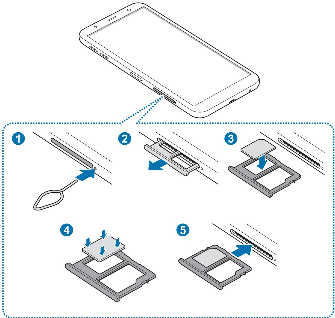
1 Inserite l'estrattore metallico nella fessura del supporto per allentare il supporto.
