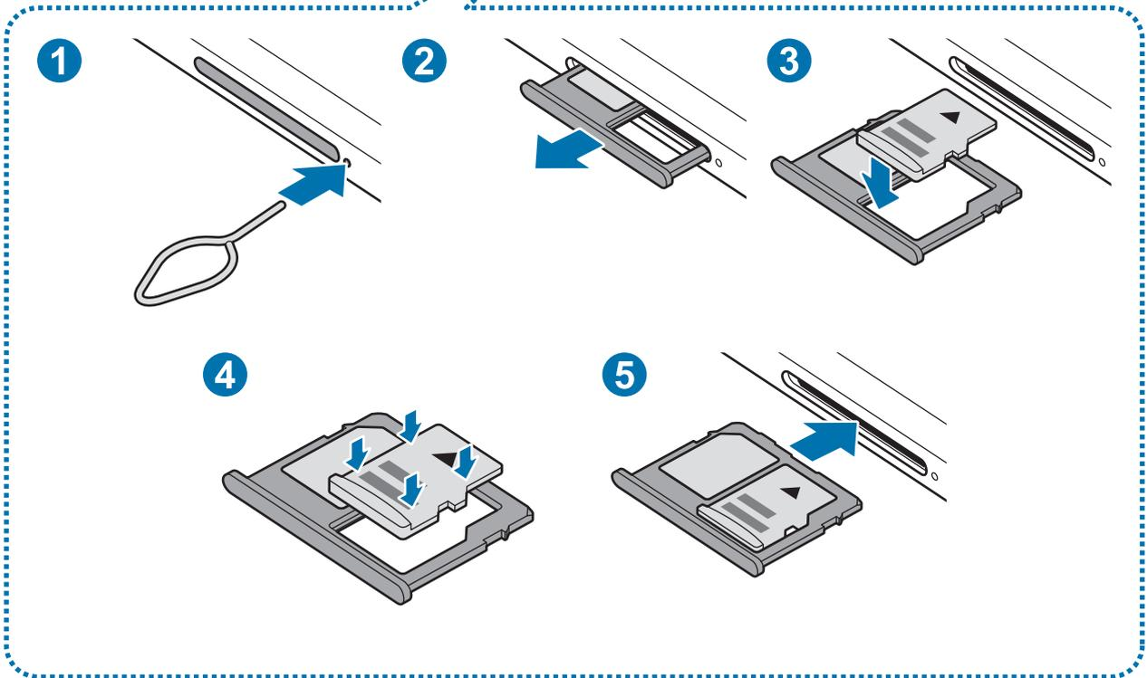
1 Inserite l'estrattore metallico nella fessura del supporto per allentare il supporto.
