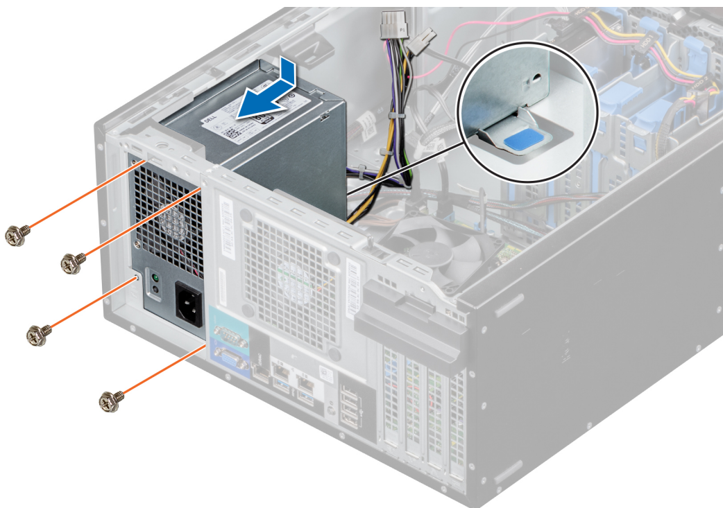
Figura 45. Instalación de la PSU
