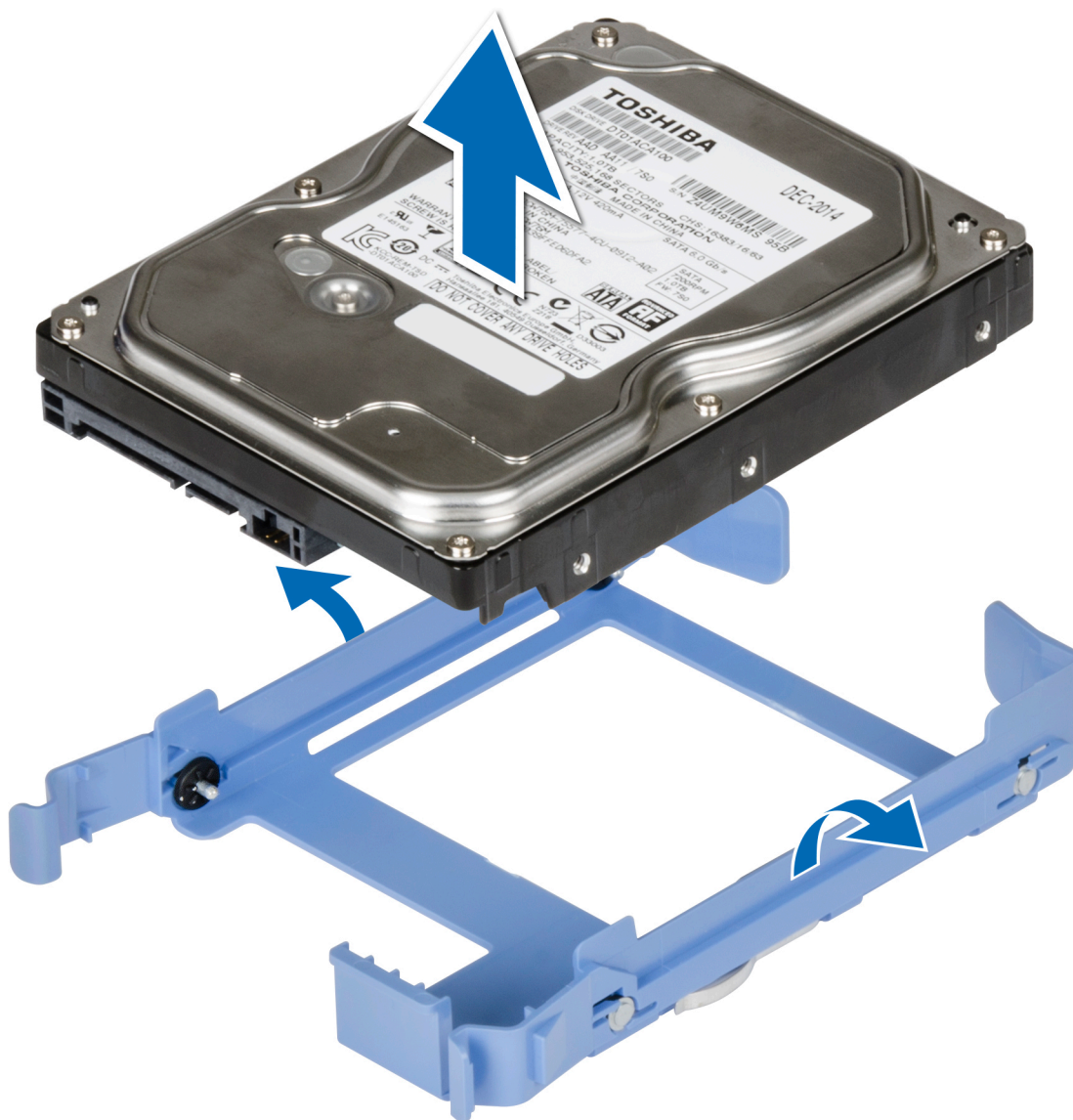
Figura 15. Extracción de la unidad del portaunidades
