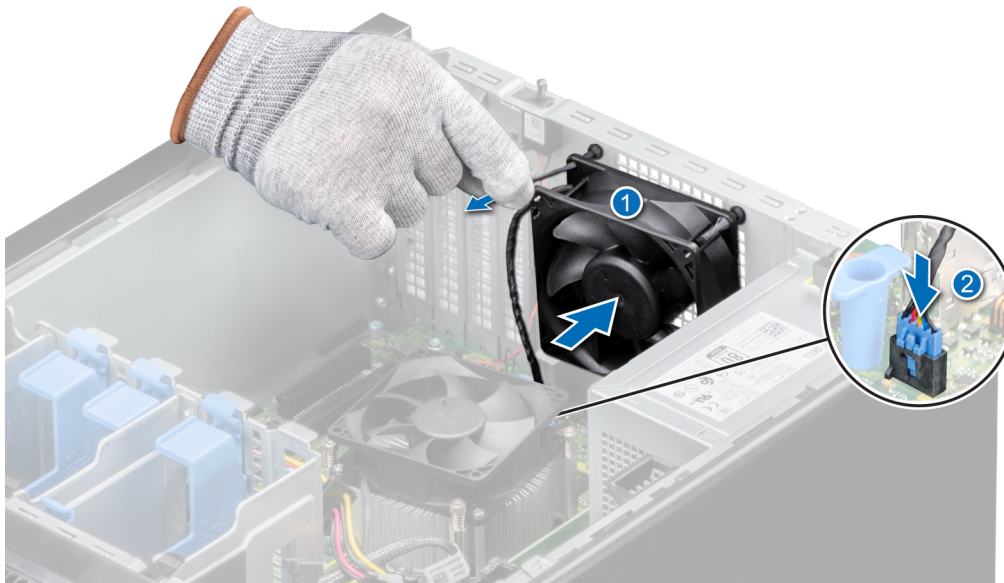
Figura 27. Instalación de un ventilador de refrigeración
