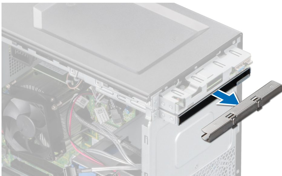
Figura 18. Extracción de la unidad óptica de relleno de la canastilla para unidad óptica
