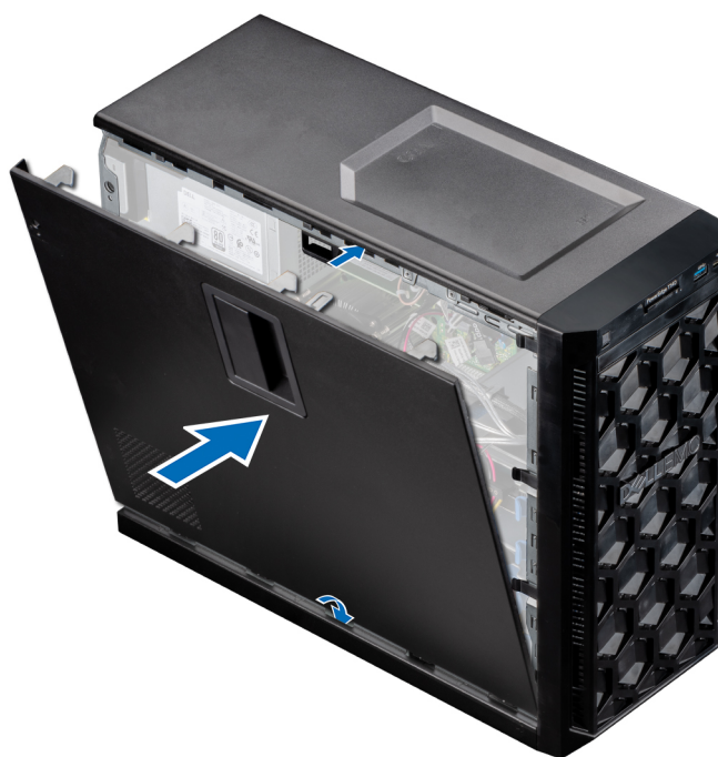
Figura 10. Instalación de la cubierta del sistema
