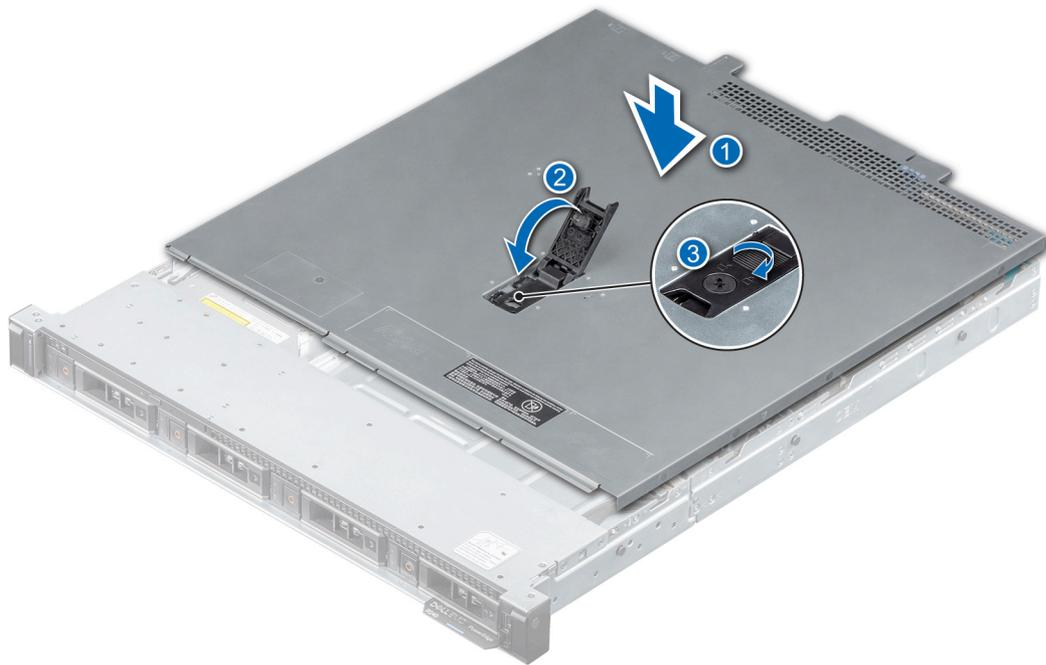
Abbildung 12. Installieren der Systemabdeckung
