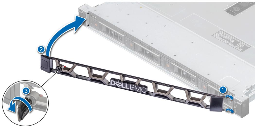
Abbildung 10. Installieren der Frontverkleidung
