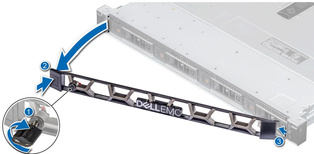
Abbildung 9. Entfernen der Frontverkleidung
