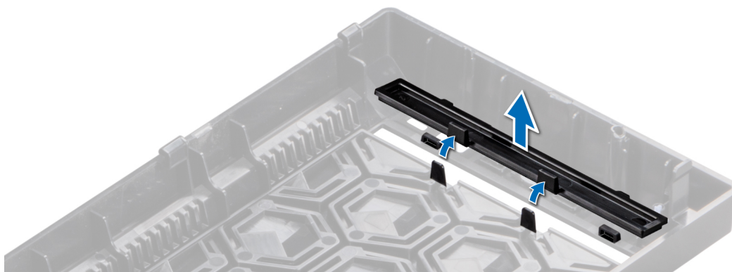
Figure 17. Retrait de la plaque de recouvrement du lecteur optique installée sur le cadre avant
