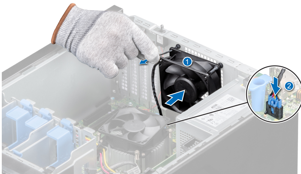
Figure 27. Installation d'un ventilateur de refroidissement
