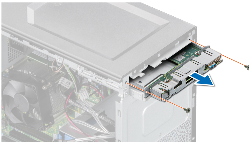
Figure 54. Retrait du bâti du panneau de commandes
