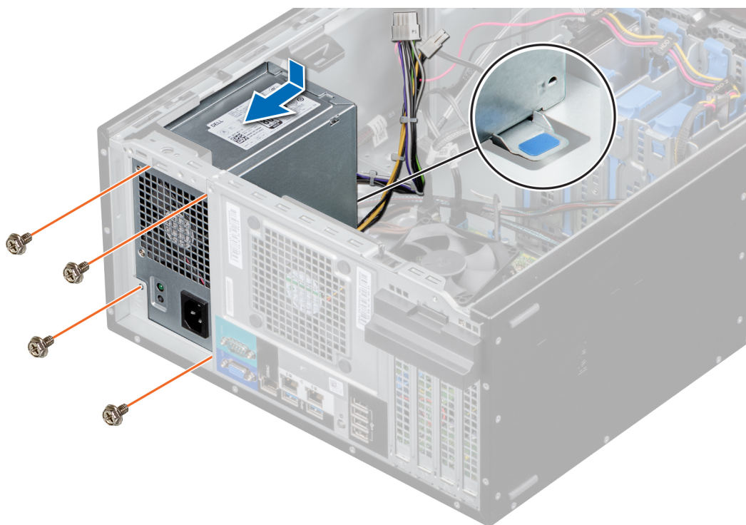
Figure 45. Installation du bloc d'alimentation
