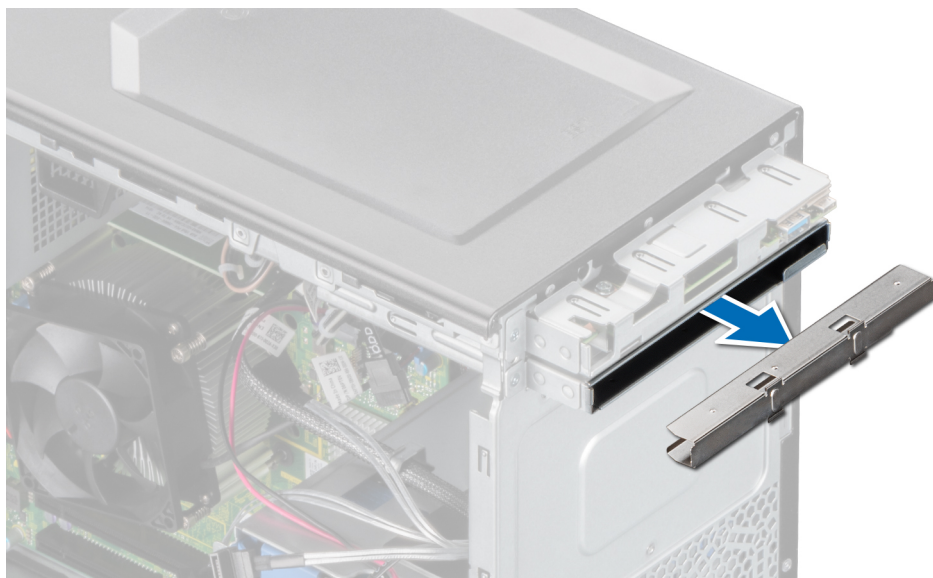
Figure 18. Retrait de la plaque de recouvrement du lecteur optique installée dans le bâti du lecteur optique
