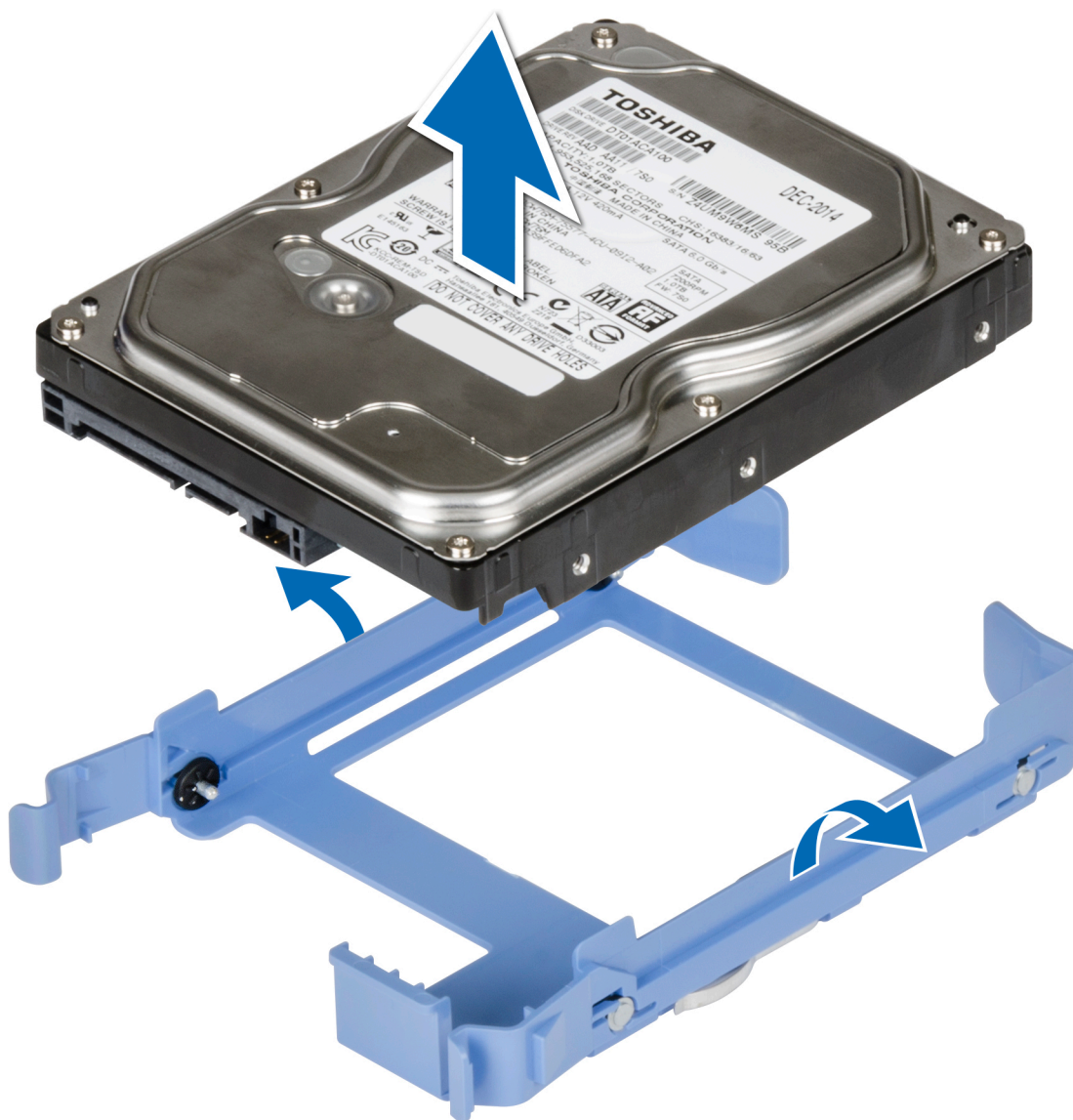
Figure 15. Retrait d'un disque dur installé de son support
