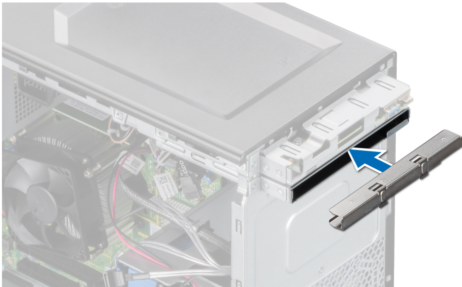
Abbildung 20. Anbringen der Abdeckung des optischen Laufwerks im Gehäuse des optischen Laufwerks
