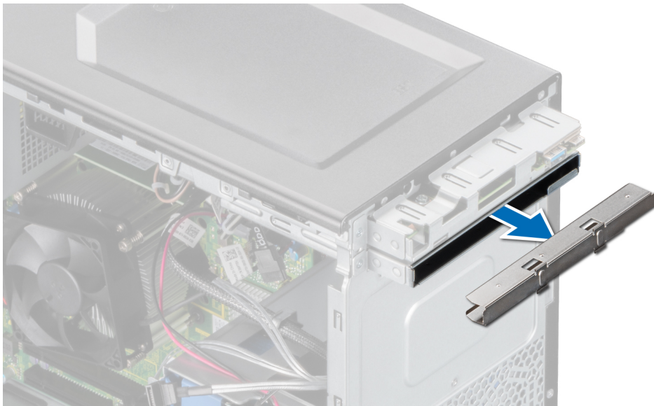
Abbildung 18. Entfernen der Abdeckung des optischen Laufwerks aus dem Gehäuse des optischen Laufwerks
