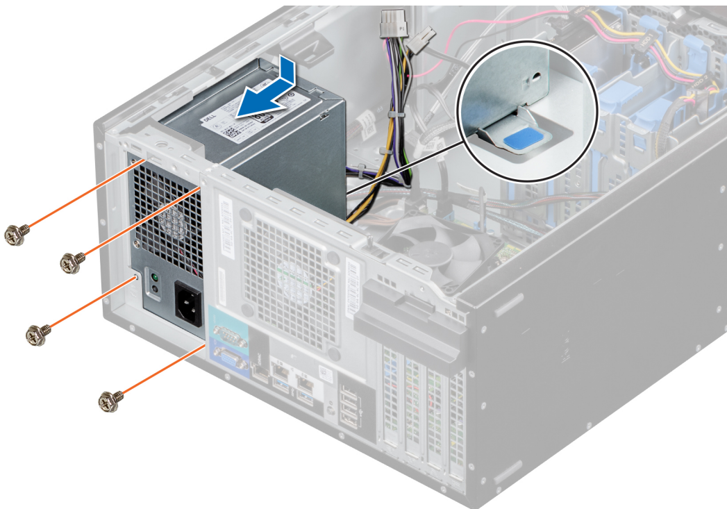
Abbildung 45. Installieren des Netzteils
