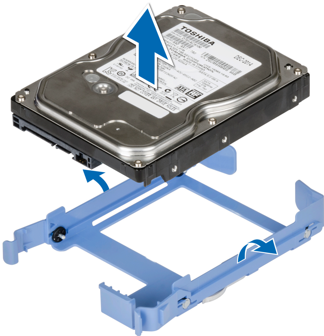
Abbildung 15. Entfernen des Laufwerks aus dem Laufwerksträger
