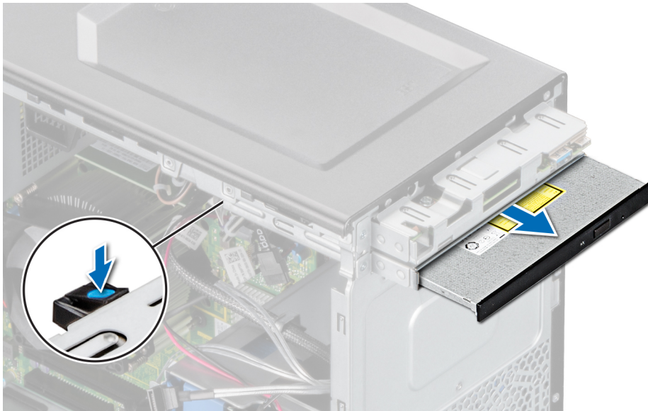
Abbildung 21. Entfernen des optischen Laufwerks
