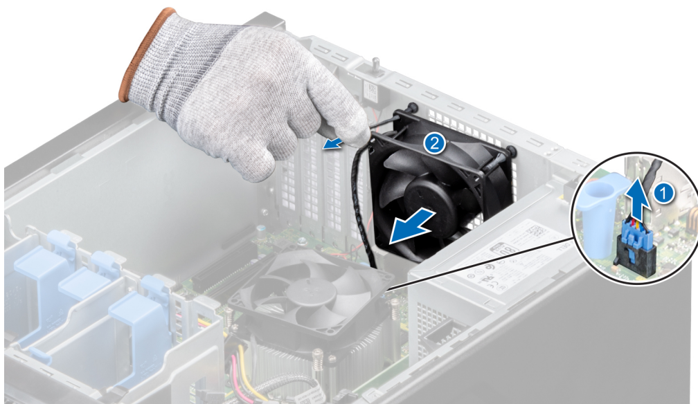
Abbildung 26. Entfernen des Kühlungslüfters
