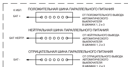
СХЕМА ЭЛЕКТРИЧЕСКИХ СОЕДИНЕНИЙ ШИН ПАРALLELЬНОГО ПИТАНИЯ В ШКАФУ 1
