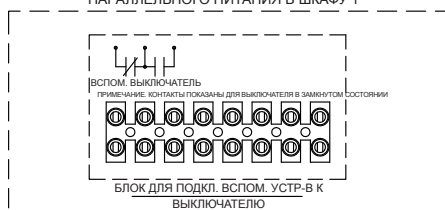
СХЕМА ЭЛЕКТРИЧЕСКИХ СОЕДИНЕНИЙ АВТОМАТИЧЕСКОГО ВЫКЛЮЧАТЕЛЯ В ШКАФУ 1
