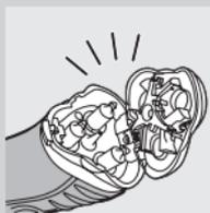
**5** 再一次打開電鬍刀組並保持開啟，讓電鬍刀完全晾乾。
