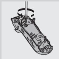
**5** 拧开密封电源部件中的三个螺丝。
