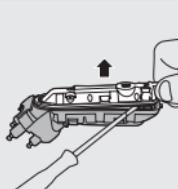
**7** Rimuovete il pannello posteriore del gruppo di alimentazione per mezzo di un giravite.
