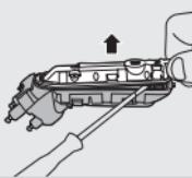
**7** Entfernen Sie die Rückseite der versiegelten Elektronikeinheit mit einem Schraubendreher.
