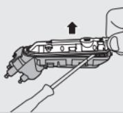
**7** Retirez le panneau arrière du bloc d'alimentation à l'aide d'un tournevis.
