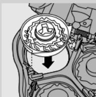
**4** Retirez les têtes de rasage usées et placez-en de nouvelles dans l'unité de rasage. Remontez le système de fixation et faites-le tourner dans le sens des aiguilles d'une montre.
