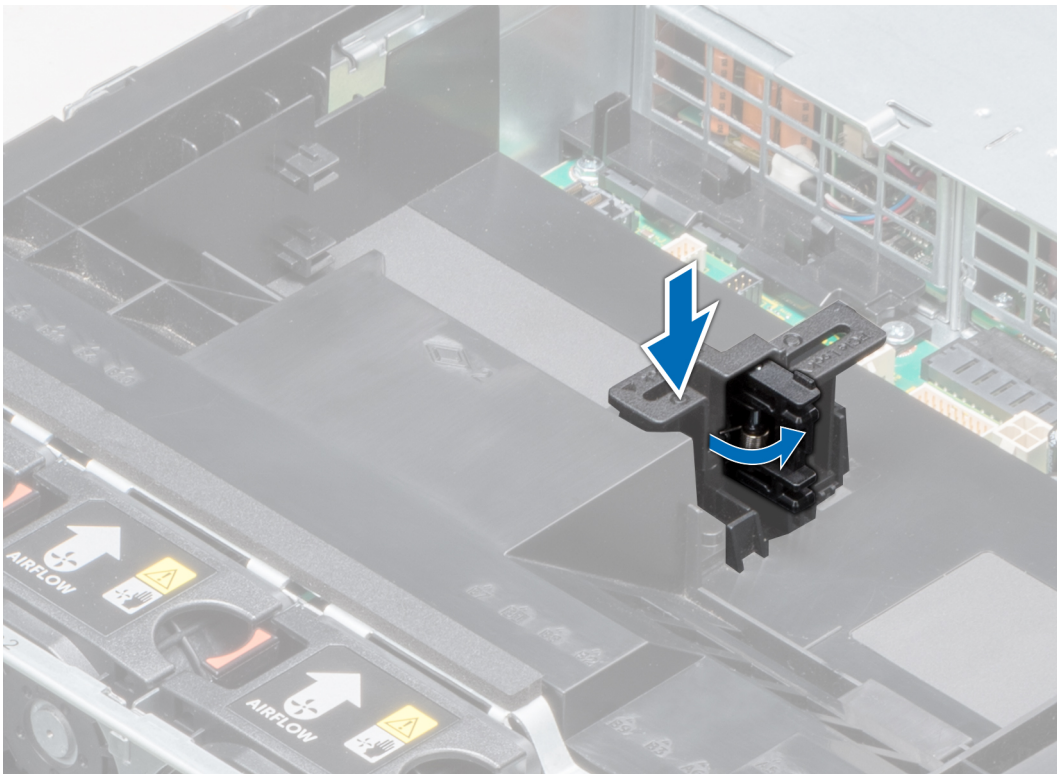
Figure 55. Ouverture du loquet du support de carte PCIe
