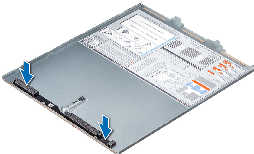
Figure 88. Installation de mousse en mylar sur le capot du système
