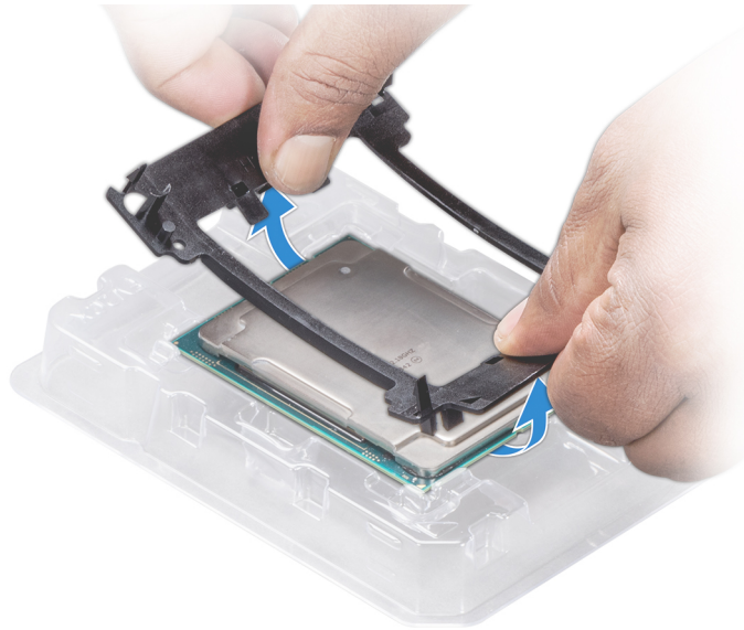
Abbildung 50. Entfernen der Prozessorhalterung
