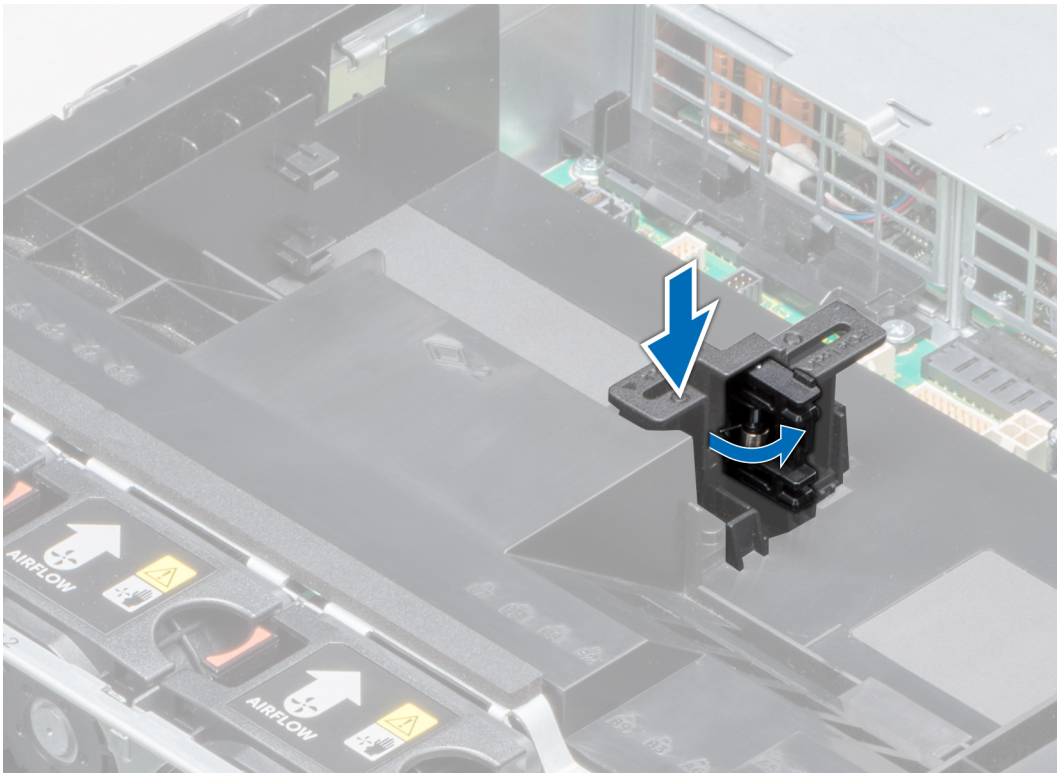
Abbildung 55. Öffnen des PCIe-Kartenhalterverriegelung
