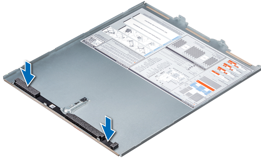
Abbildung 88. Anbringen des Schutzschaums an der Systemabdeckung
