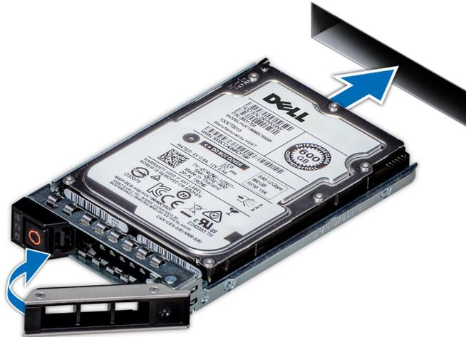
Ilustración 74. Instalación de una unidad de disco duro
