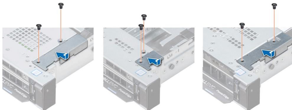
**Ilustración 112. Instalación de la cubierta de cables**
