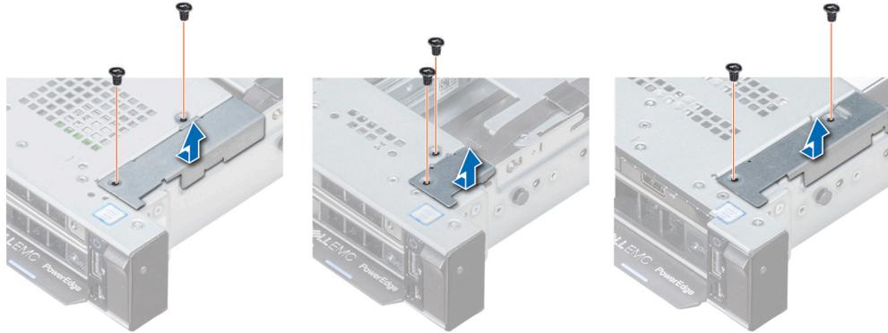
**Ilustración 109. Extracción de la cubierta de cables**
