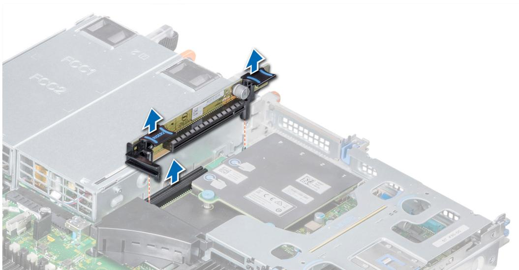
Ilustración 46. Extracción del soporte vertical para tarjetas de expansión 2A
