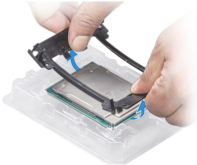
**Ilustración 39. Extracción del soporte del procesador**
