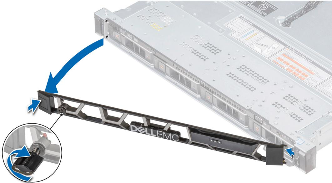
Ilustración 19. Extracción del bisel frontal opcional con el panel LCD
