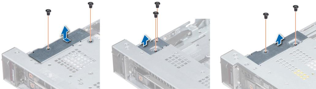
Ilustración 105. Extracción de la cubierta de cables
