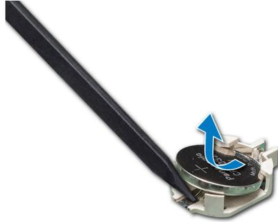
**Ilustración 92. Extracción de la batería del sistema**
