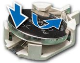
**Ilustración 93. Instalación de la batería del sistema**
