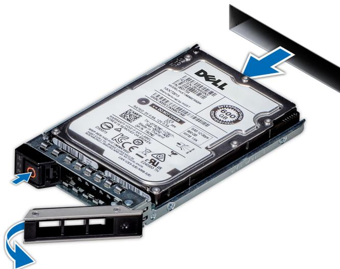
Ilustración 73. Extracción de una unidad de disco duro
