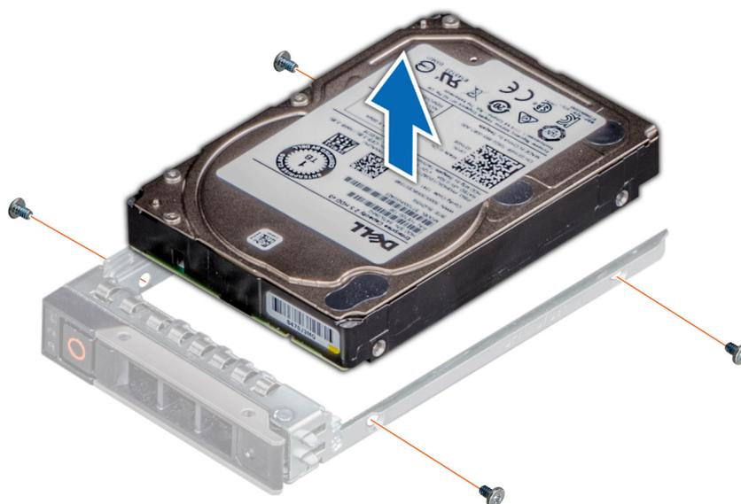
**Ilustración 75. Extracción de una unidad de disco duro del portaunderes de disco duro**
