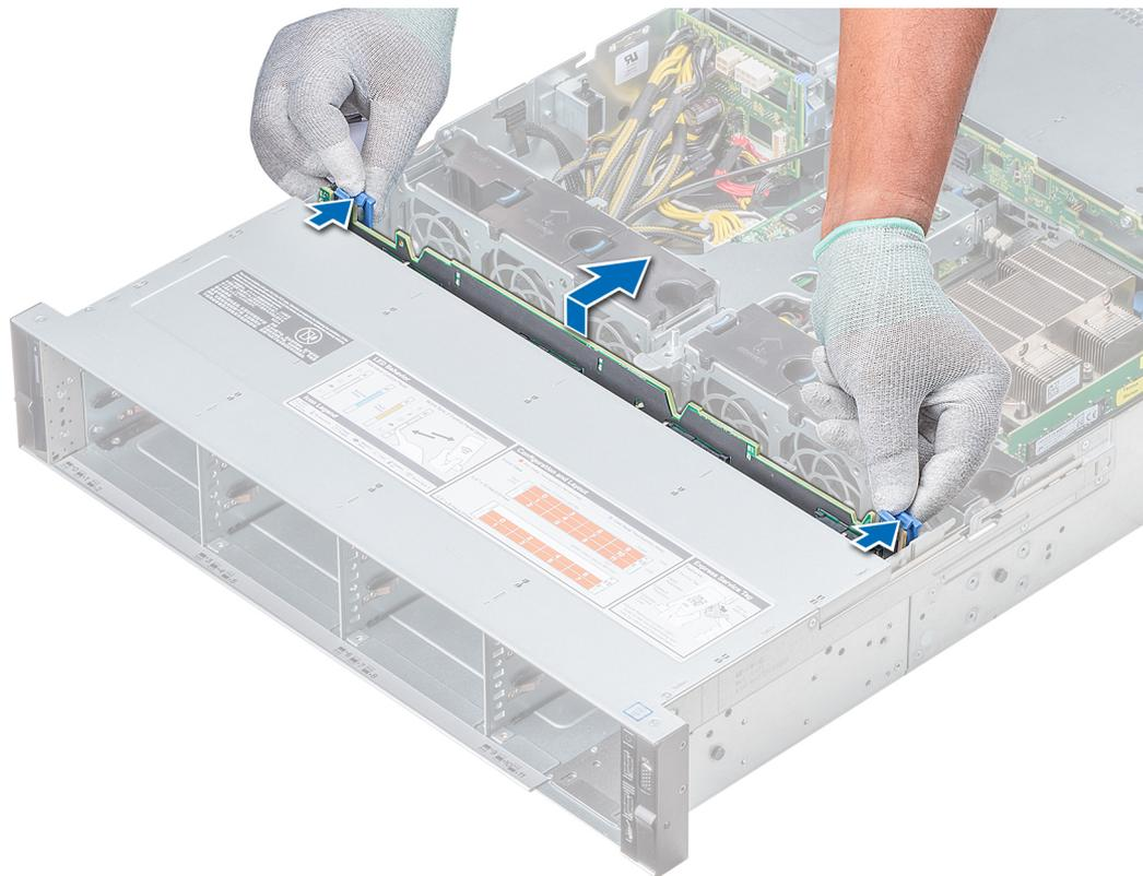
**Abbildung 92. Entfernen der Laufwerksrückwandplatte**
