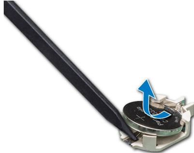
Abbildung 102. Entfernen der Systembatterie
