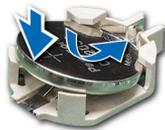
Abbildung 103. Installieren der Systembatterie
