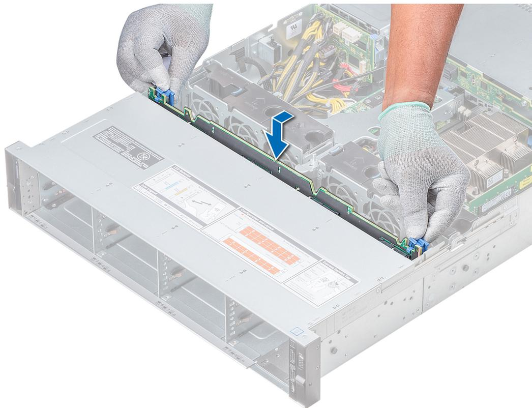
**Abbildung 93. Installieren der Laufwerksrückwandplatine**
