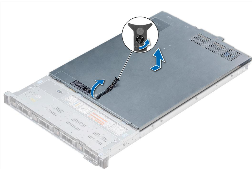
Figure 21. Retrait du capot du système
