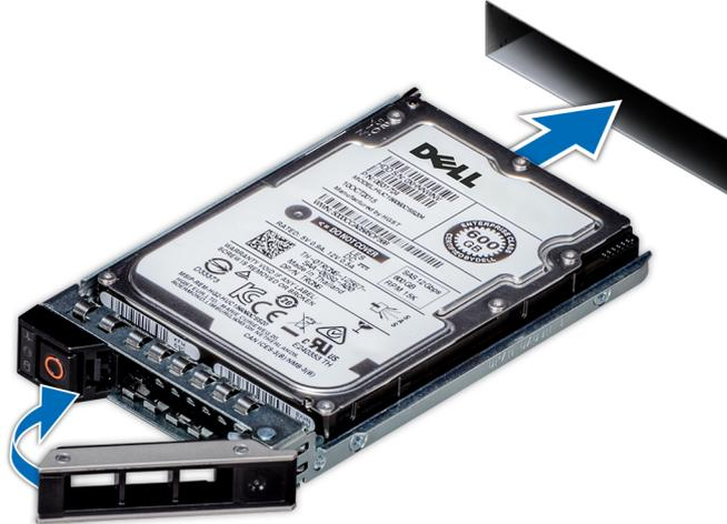
Figure 74. Installation d'un disque dur
