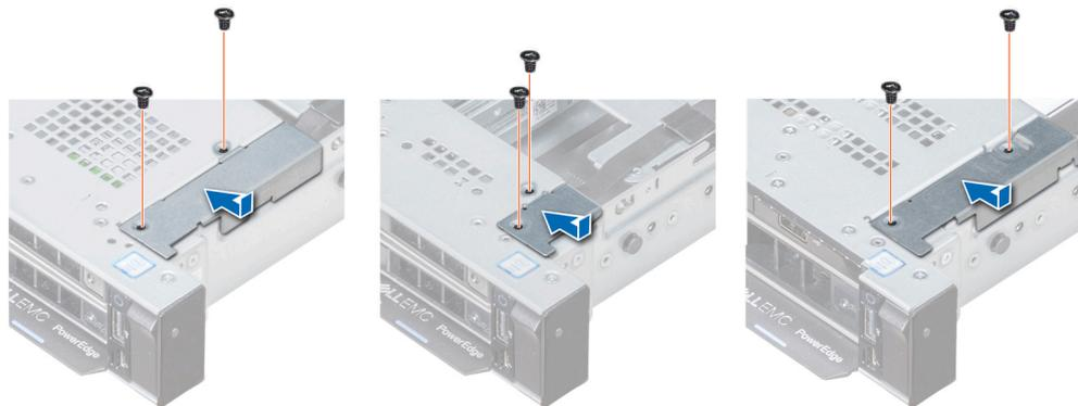
Figure 112. Installation du cache-câbles
