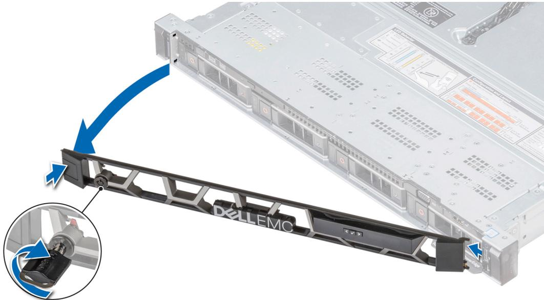
Figure 19. Retrait du cadre avant en option. à l'écran LCD
