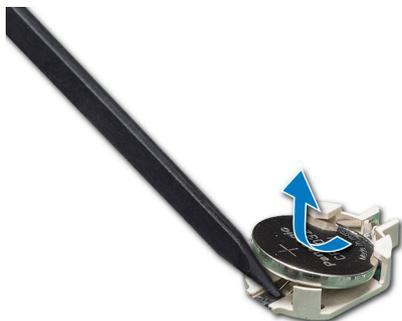
**Figure 92. Retrait de la pile du système**
