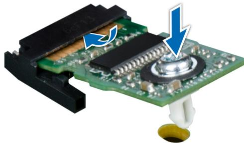
Figure 104. Installer le module TPM
