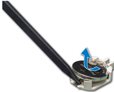
Figura 102. Extracción de la batería del sistema
