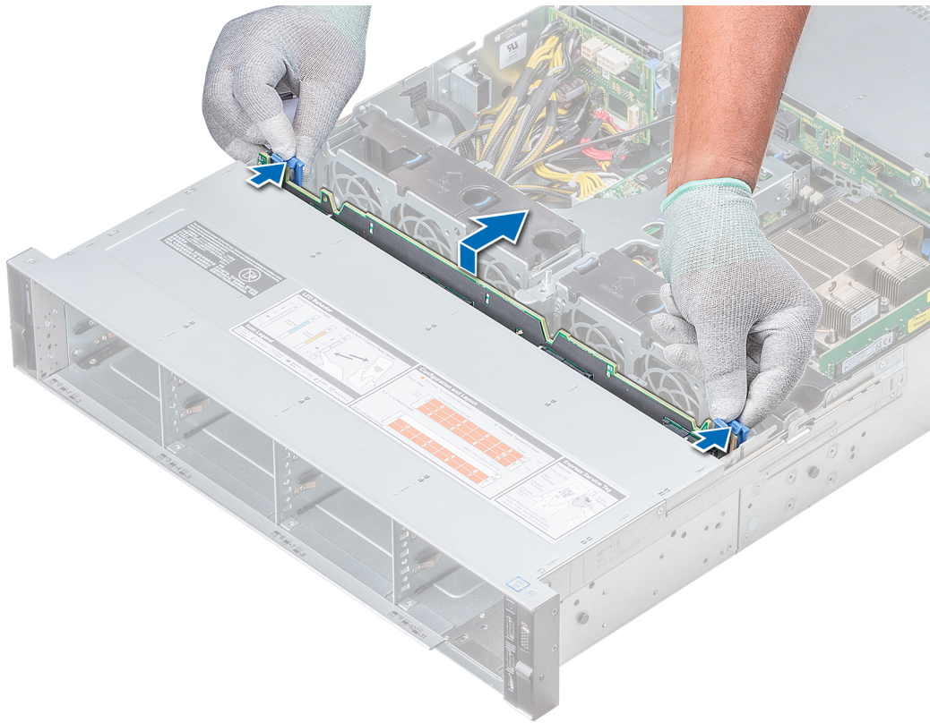
Figura 92. Desmontaje del plano posterior de la unidad
