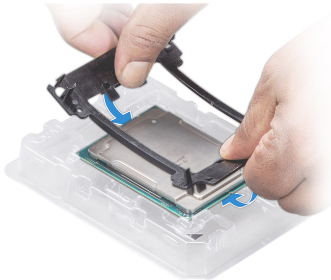
Figure 56. Installation du support de processeur
