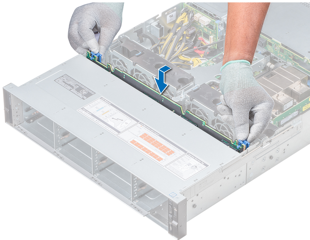
Figure 93. Installation du fond de panier des disques
