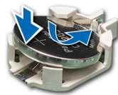
Figure 103. Installation de la pile du système
