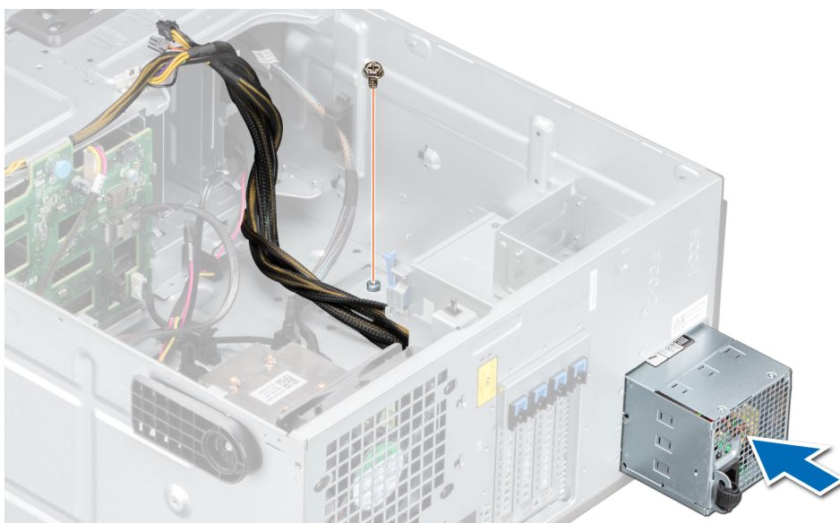
Figura 75. Instalación de una unidad de fuente de alimentación cableada
