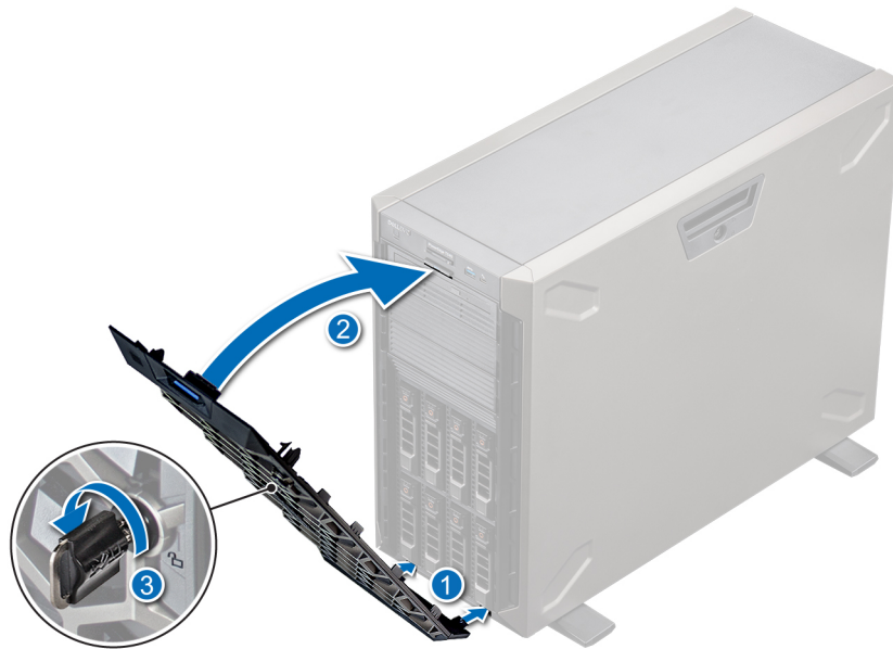
Figura 18. Instalación del bisel frontal
