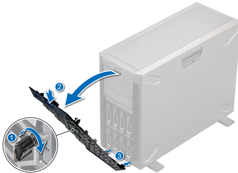
Abbildung 17. Entfernen der Frontverkleidung
