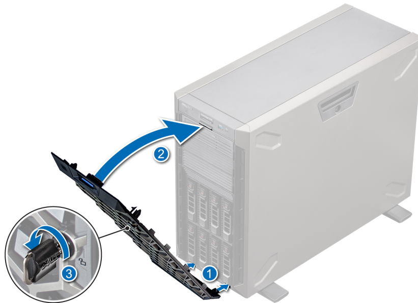
Abbildung 18. Installieren der Frontverkleidung
