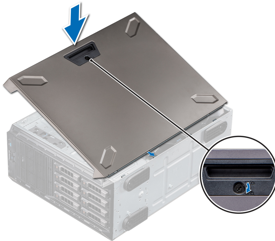
Abbildung 23. Installieren der Systemabdeckung
