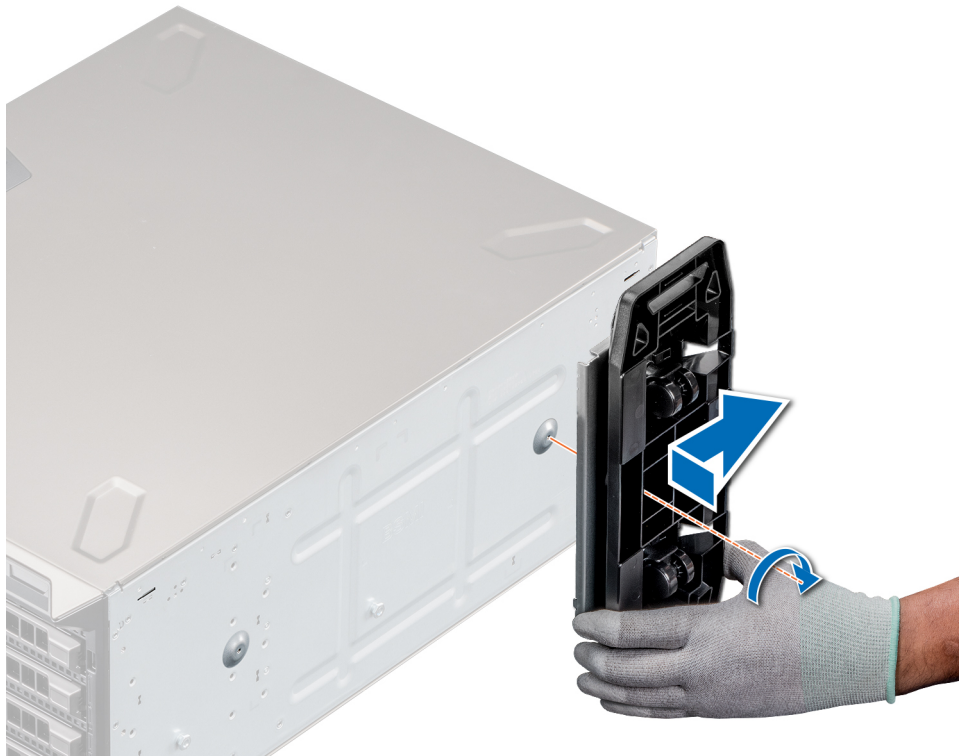
Abbildung 21. Installieren von Gleitrollen
