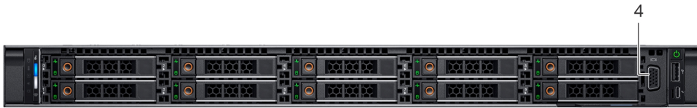
Abbildung 3. Vorderansicht des Systems mit 10 x 2,5-Zoll-Laufwerken
