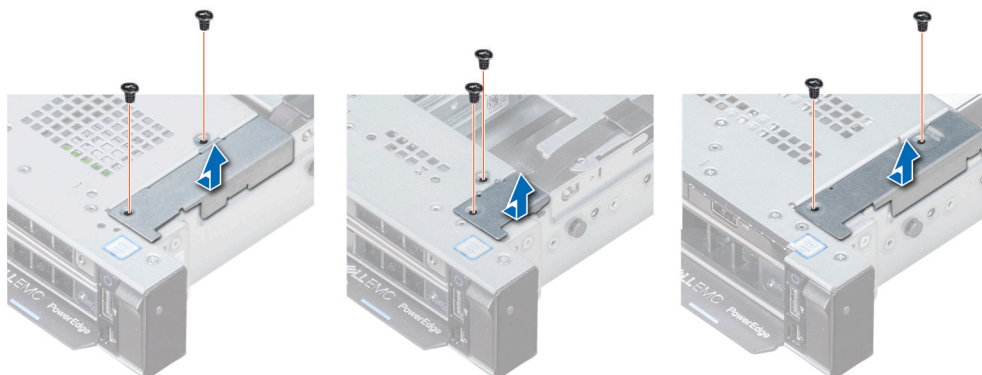
Abbildung 102. Entfernen der Kabelabdeckung
