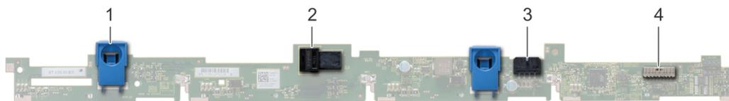
**Figure 75. Fond de panier pour 4 disques de 3,5 pouces**
