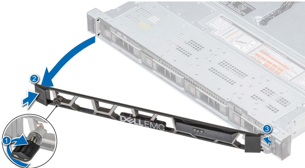
Figure 17. Retrait du cadre avant avec écran LCD
