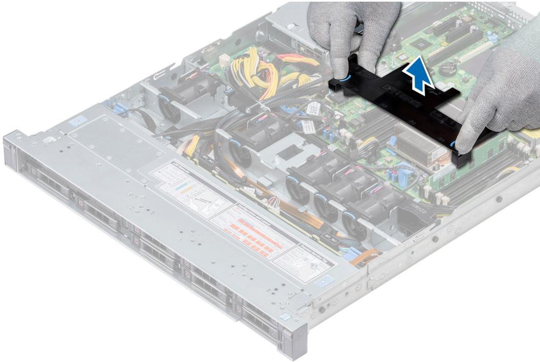
**Figure 24. Retrait du carénage d'aération**
