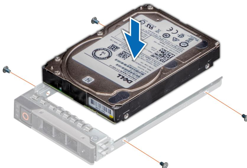
Figure 39. Installation d'un disque dans son support
