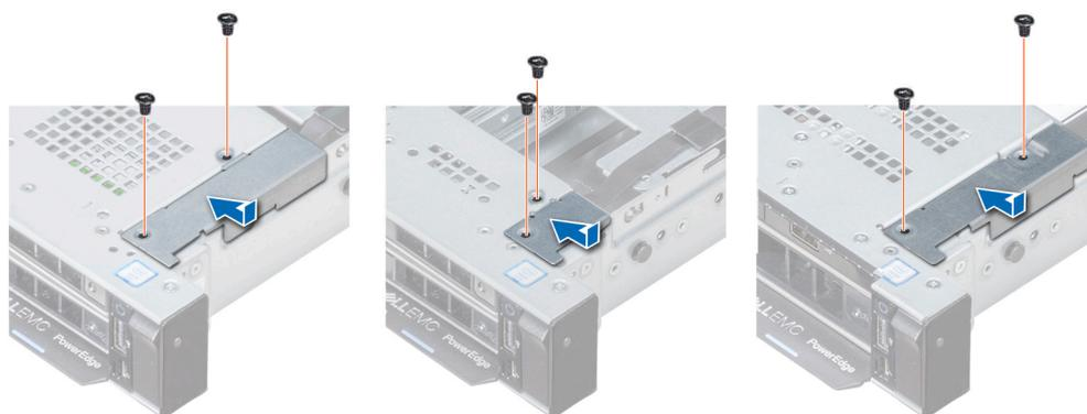
**Figure 105. Installation du cache-câbles**
