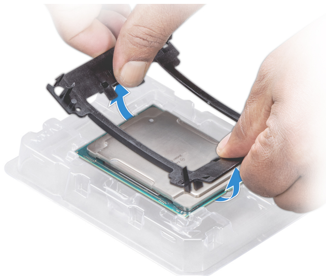
Figura 44. Extracción del soporte del procesador
