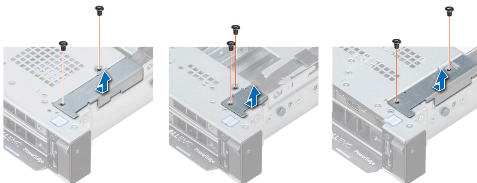
Figura 102. Extracción de la cubierta de cables
