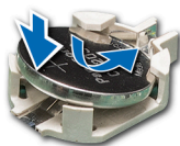
Figura 88. Instalación de la batería del sistema
