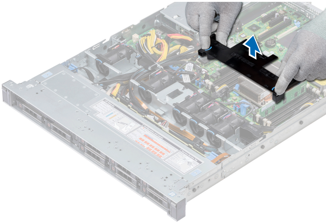
Figura 24. Extracción la cubierta para aire
