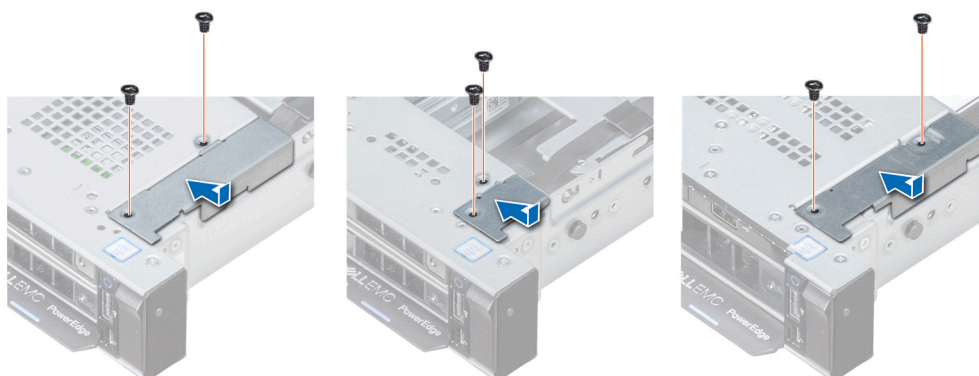
Figura 105. Instalación de la cubierta de cables
