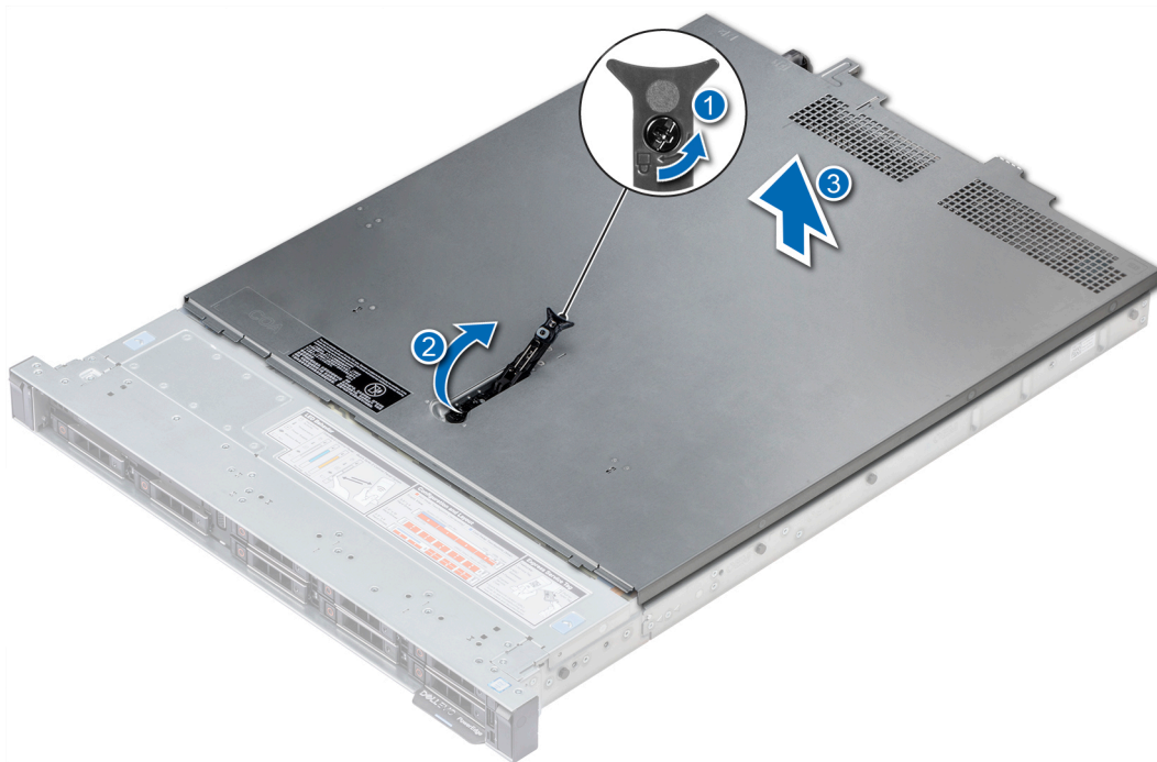
Figura 19. Extracción de la cubierta del sistema
