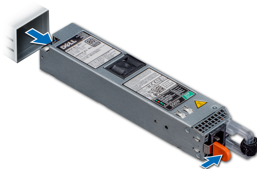
Figura 93. Extracción de una unidad de fuente de alimentación
