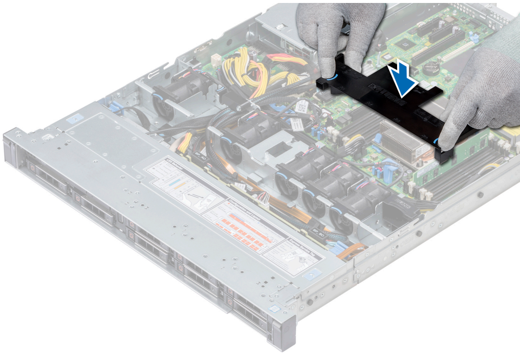
Figura 25. Instalación de la cubierta para aire
