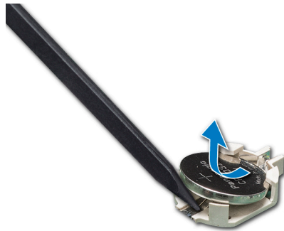
Figure 89. Retrait de la pile du système
