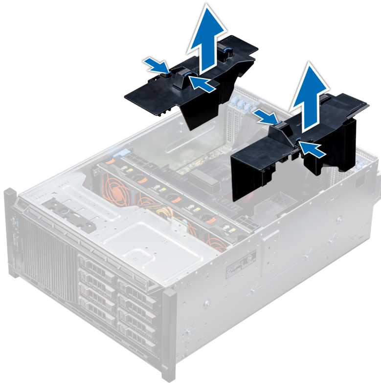
Figure 36. Retrait des carénages à air de processeur graphique (en option)
