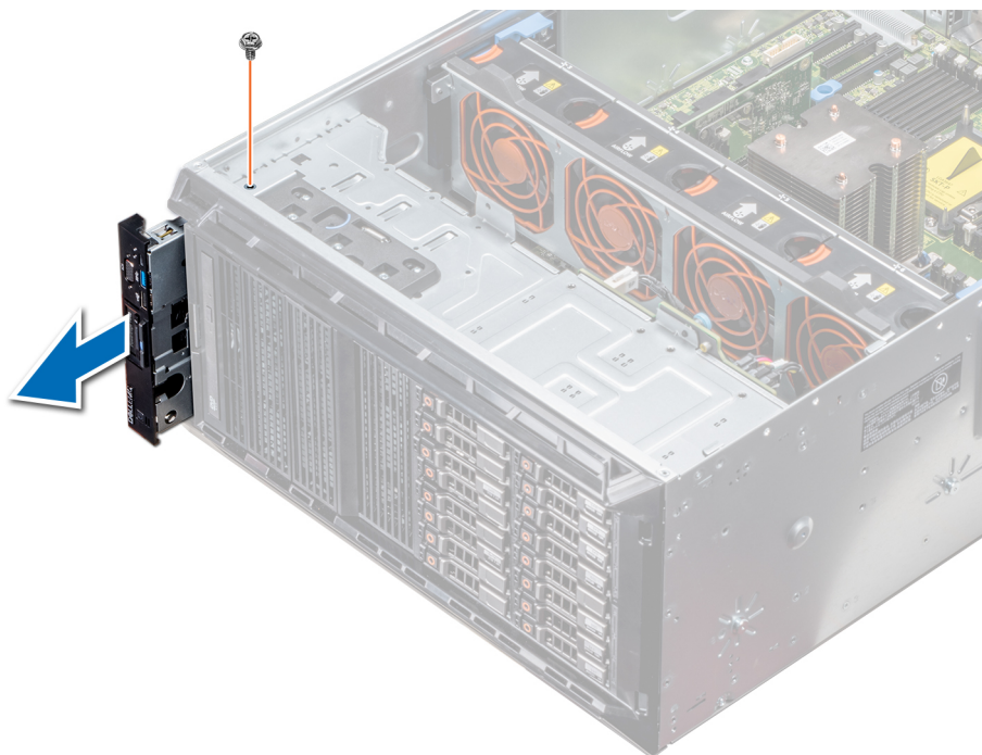
Figure 101. Retrait de l'assemblage du panneau de commande
