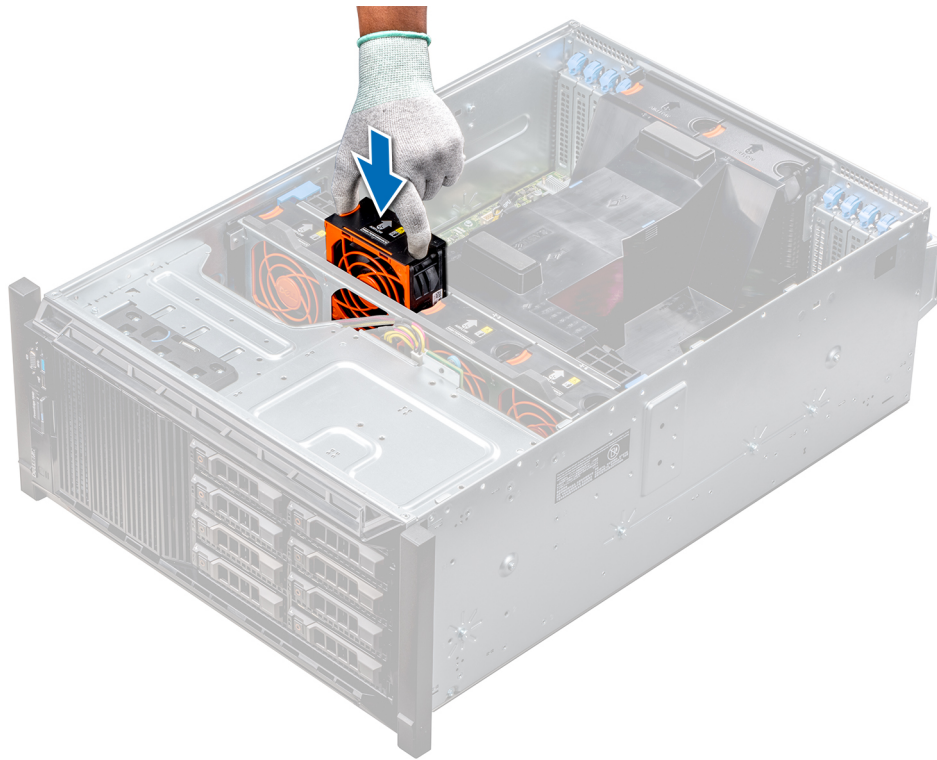
Figure 41. Installation d'un ventilateur de refroidissement
