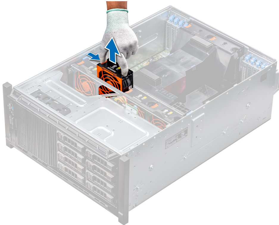
Figure 40. Retrait d'un ventilateur de refroidissement
