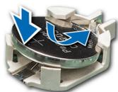
Abbildung 90. Installieren der Systembatterie
