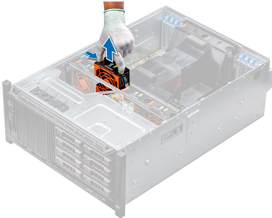
Abbildung 40. Entfernen eines Kühlungslüfters
