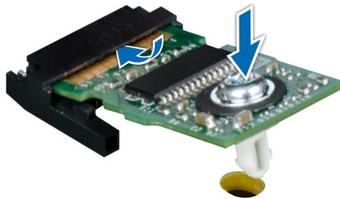
Abbildung 91. Installieren des TPM-Moduls
