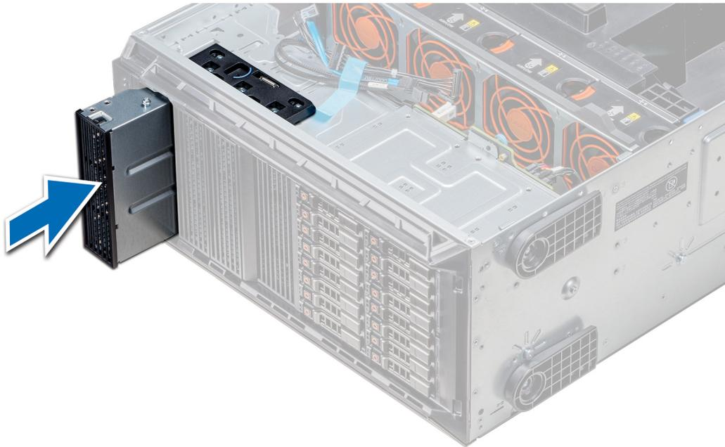
Abbildung 49. Installieren des Platzhalters für optische Laufwerke oder Bandlaufwerke
