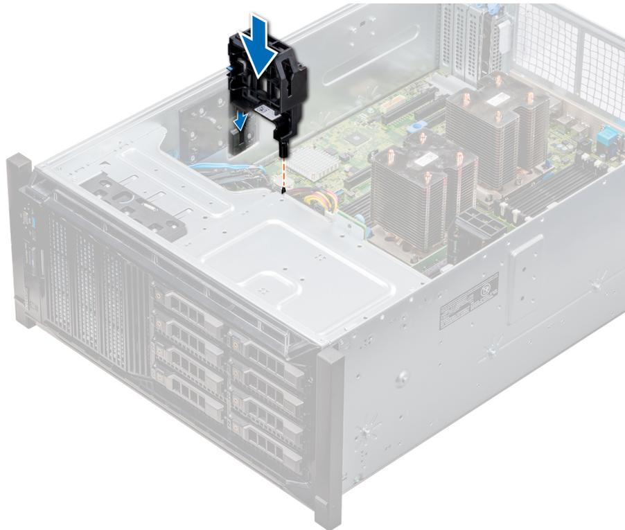
Abbildung 68. Installieren des optionalen GPU-Kartenhalters
