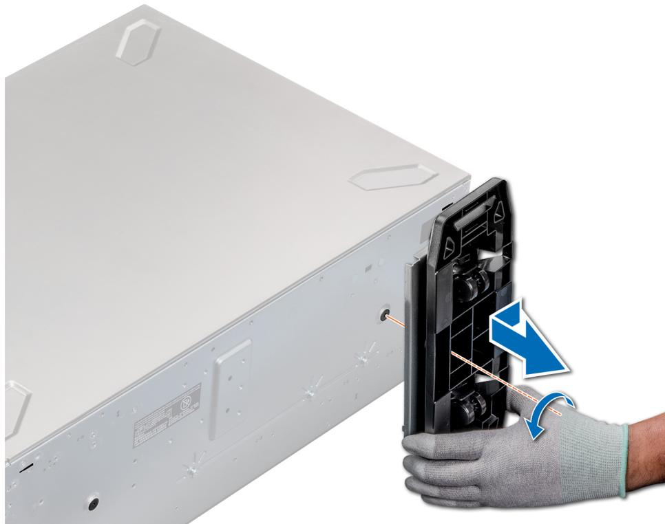
**Abbildung 19. Entfernen von Gleitrollen**
