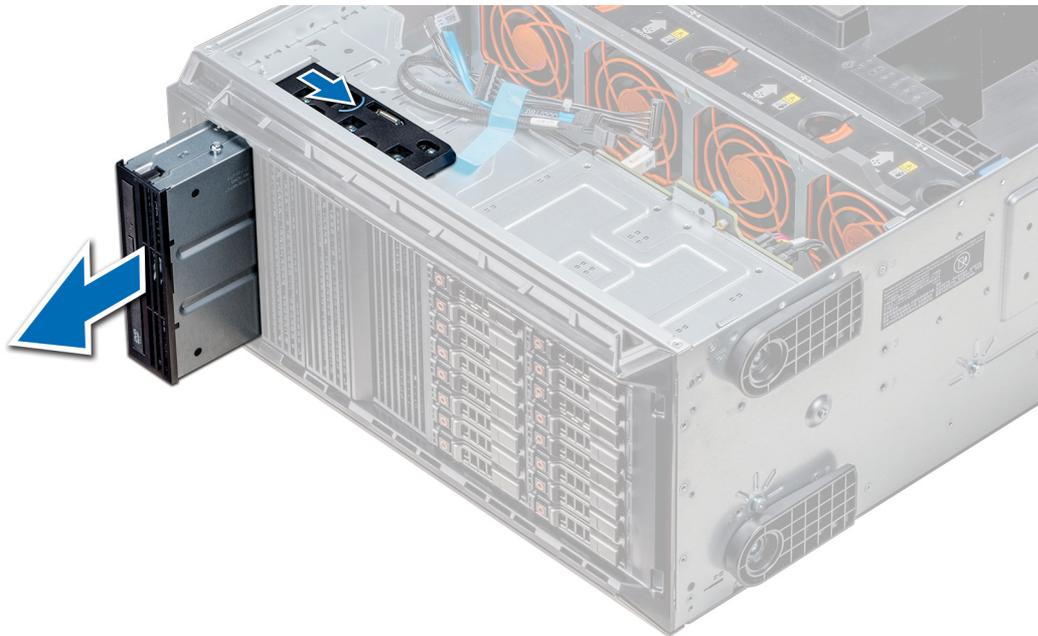
Abbildung 50. Entfernen des optischen Laufwerks oder des Bandlaufwerks
