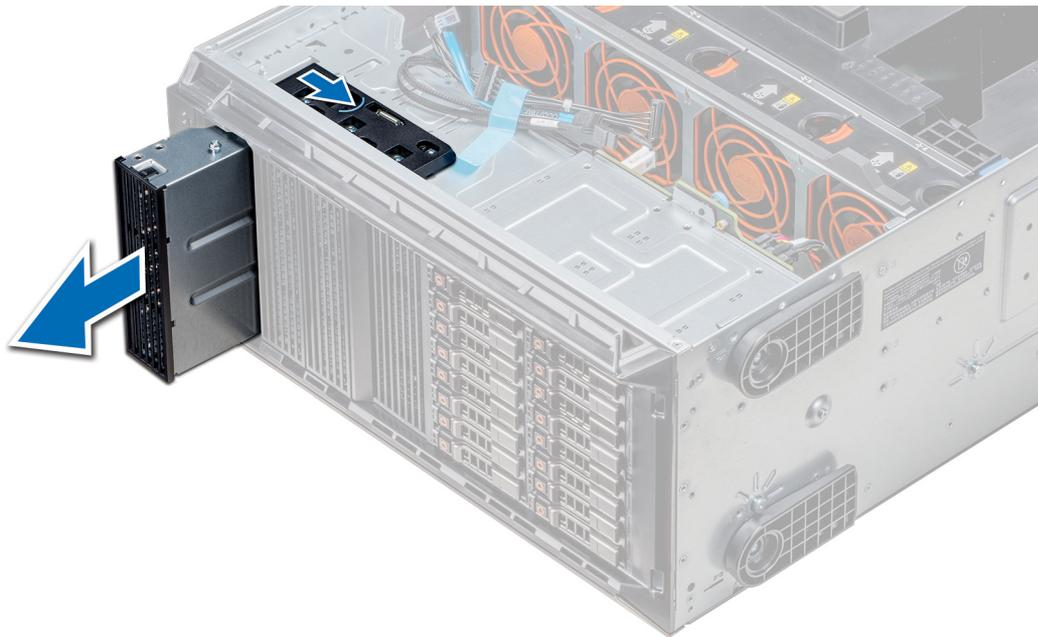
Abbildung 48. Entfernen des optischen Laufwerks oder Bandlaufwerks
