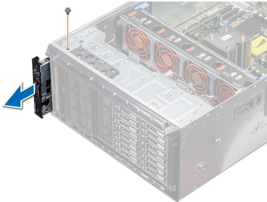
Abbildung 101. Entfernen der Bedienfeldbaugruppe
