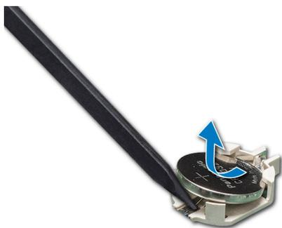
Abbildung 89. Entfernen der Systembatterie
