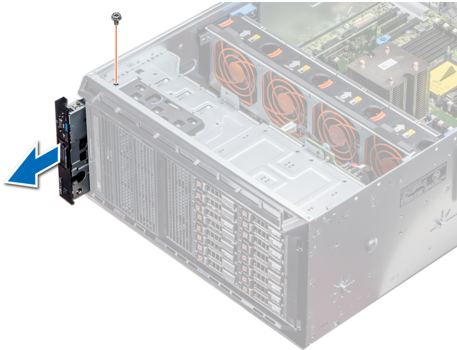
Figura 101. Extracción del ensamblaje del panel de control
