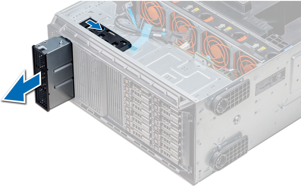
Figura 48. Extracción de la unidad óptica o de cinta
