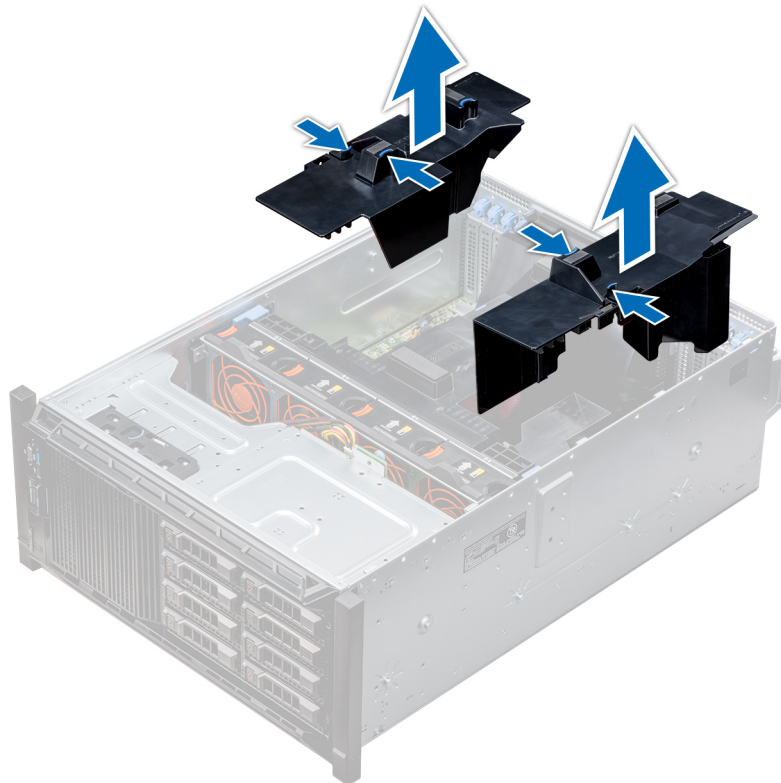
Figura 36. Extracción de las cubiertas para flujo de aire opcionales de la GPU
