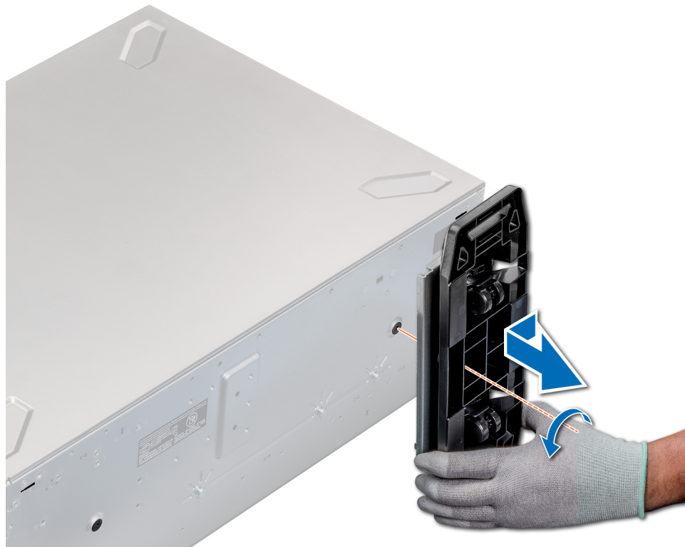
Figura 19. Extracción de las ruedas giratorias
