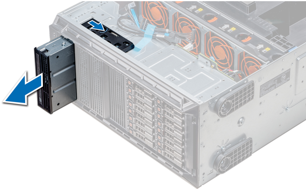
Figura 50. Extracción de la canastilla para unidad óptica o unidad de cinta
