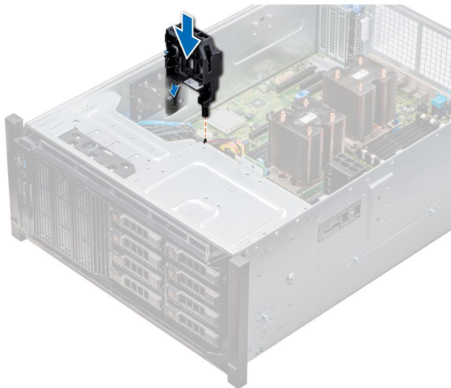
Figura 68. Instalación del soporte para tarjetas GPU
