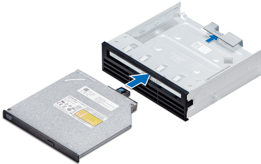
Figura 53. Instalación de la unidad óptica reducida de relleno
