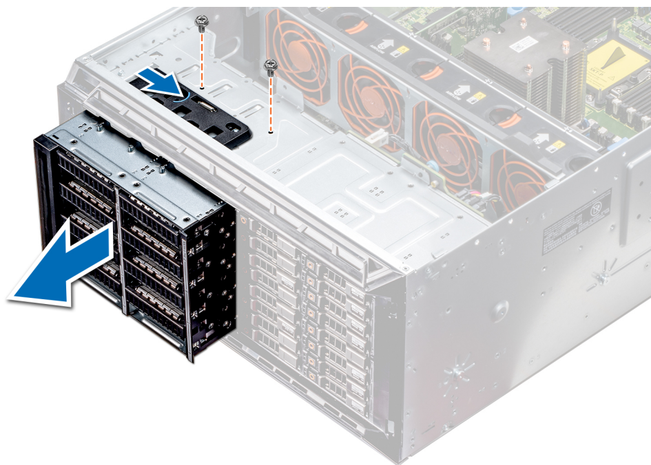
Figura 46. Extracción de un compartimiento para unidad NVMe o FlexBay
