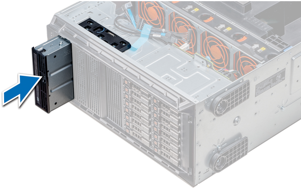
Figura 51. Instalación de la canastilla de unidad óptica o la unidad de cinta
