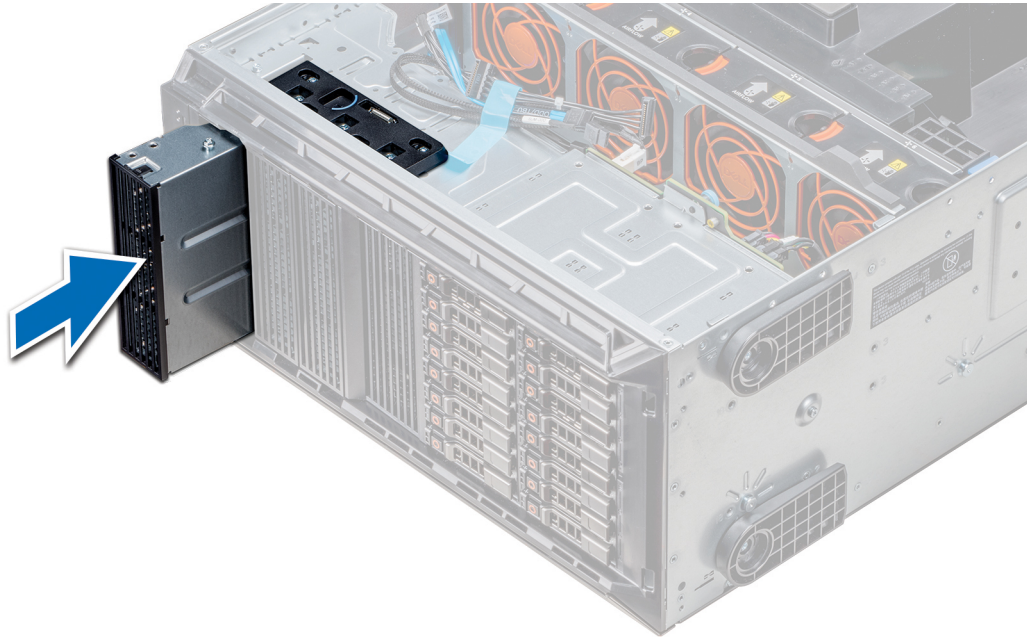
Figura 49. Instalación del panel de relleno de la unidad óptica o de cinta
