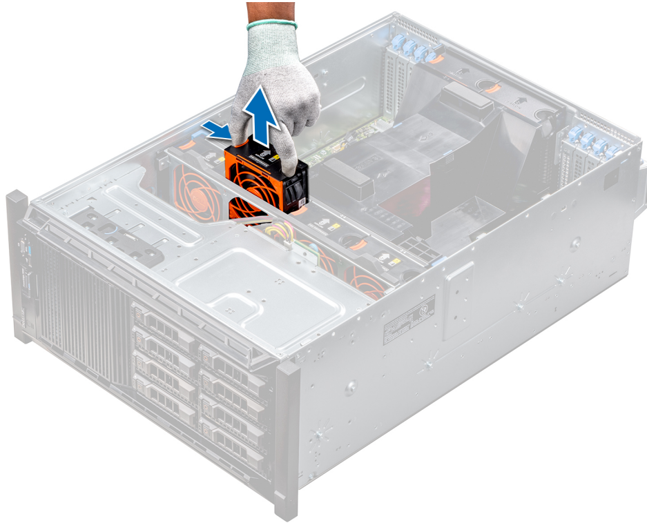
Figura 40. Extracción de un ventilador de refrigeración
