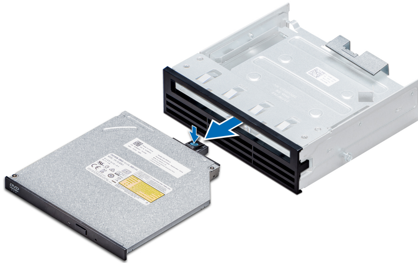
Figura 52. Extracción de la unidad óptica reducida de relleno
