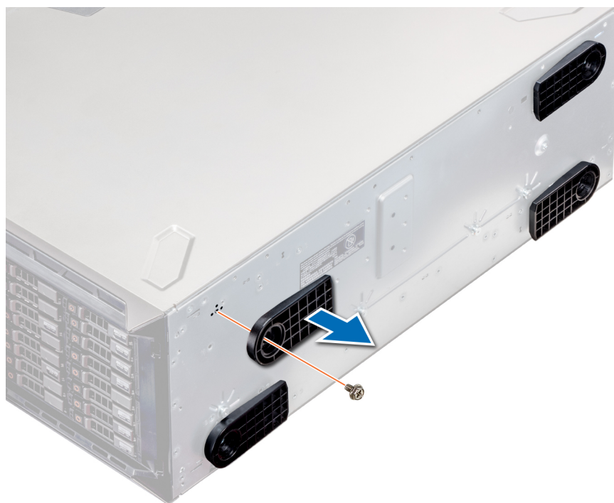
Figura 17. Extracción de los pies del sistema
