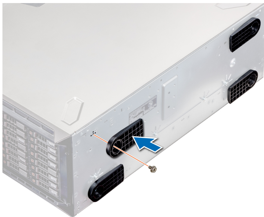
Figura 18. Instalación de los pies del sistema
