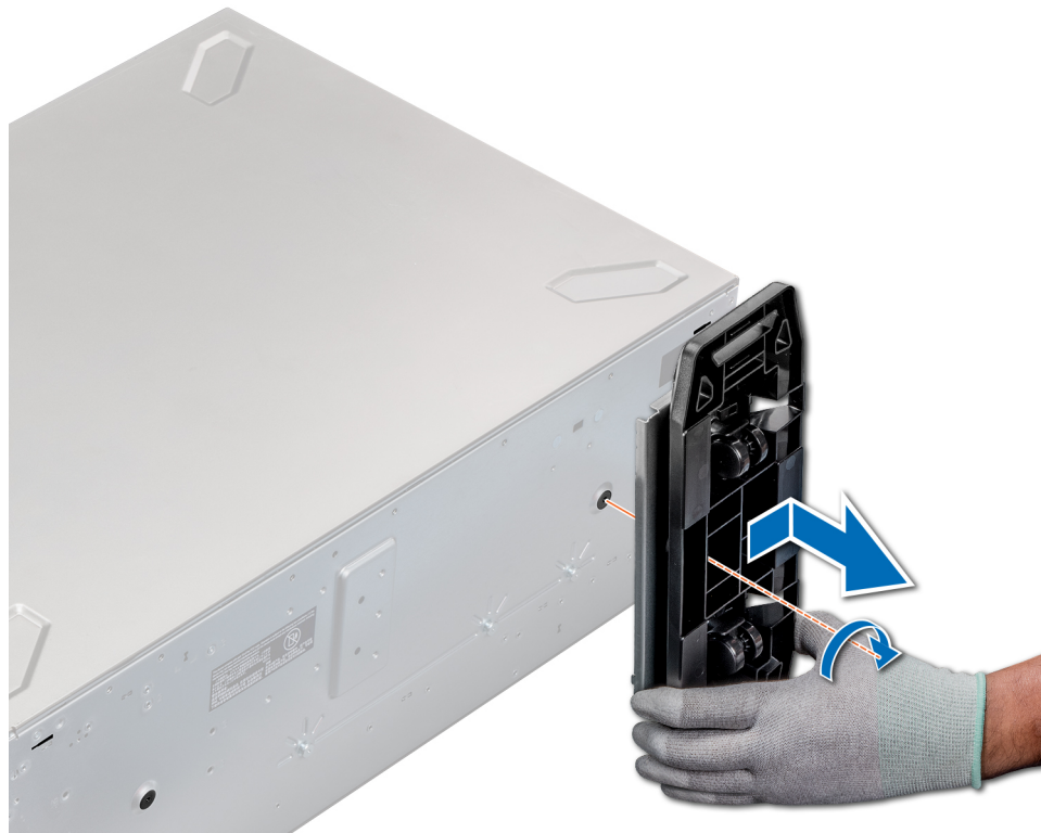
Figura 20. Instalación de las ruedas giratorias
