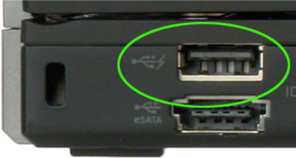
L'on ne doit utiliser qu'un connecteur USB arborant une **icône d'éclair**, comme dans l'image ci-dessus.
