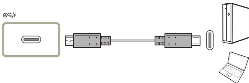
Según la especificación USB Power Delivery 2.0 (USB PD), nuestro producto puede cargar su portátil cuando lo conecte a nuestro producto mediante un cable USB Tipo-C.
