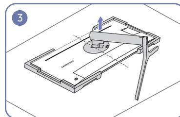
Tras girar 10° el cuello del soporte de la pantalla en el sentido contrario a las agujas del reloj, levante el cuello del soporte para separarlo del dispositivo.
