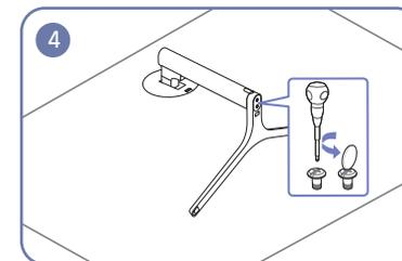
Gire el tornillo de conexión en la parte inferior del soporte para quitarlo.
