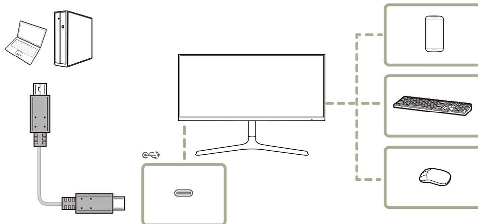
Si se conectan diversos dispositivos de fuente al PC, es probable que los cables se enreden. La conexión de los dispositivos directamente al producto soluciona este inconveniente.
