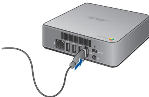
Verbinden eines Displays via Typ-C™
